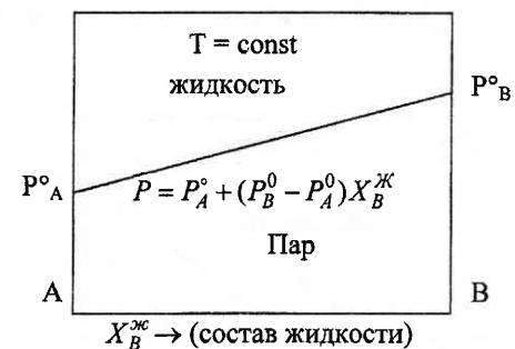
Рис. 5. Связь общего давления пара с составом раствора
