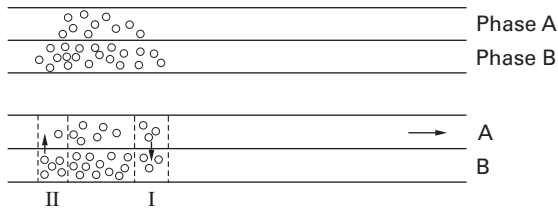
Abb. 7.1 Elementarvorgänge bei der Verteilungschromatographie.
