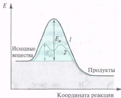
Рис. 3.4. Энергетические диаграммы для некатализуемой (1) и катализуемой (2) реакций
