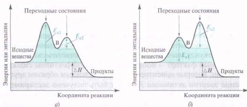
Рис. 3.2. Суммарные диаграммы изменения энергии двухстадийной реакции: a — первого типа; b — второго типа
