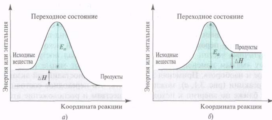
Рис. 3.1. Диаграмма изменения энергии одностадийной реакции: а — экзотермическая реакция, \Delta H < 0 ; б — эндотермическая реакция, \Delta H > 0
