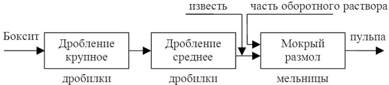
Рис. 2.1. Схема измельчения боксита
