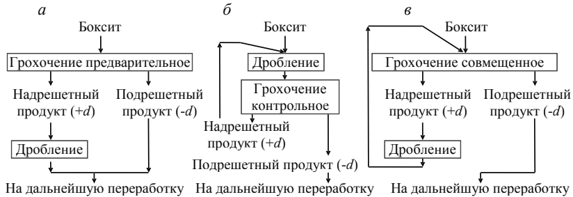
Рис. 2.3. Грохочение в сочетании с дроблением: а — предварительное; б — контрольное; в — совмещенное
