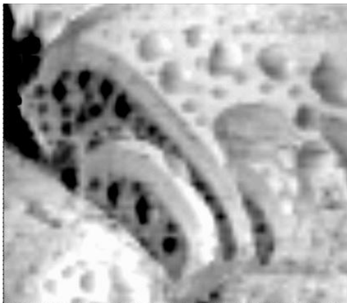
Рис. 4.7.а Латерально-силовая микроскопия разрезанного зондом зерна фоточувствительного слоя на основе \text{Pb}_{1-x}\text{Cd}_x\text{Se}<\text{I}> , размер сканируемой области 2 мкм *2 мкм
