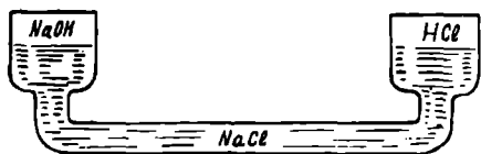
Рис. 36. Прибор для наблюдения за движением ионов \text{H}_3\text{O}^+ и \text{OH}^- .
