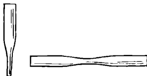
Рис. 28. Изготовление капиллярных трубок.
