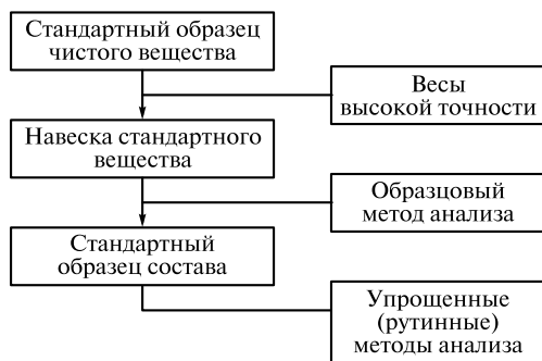
Рис. 21.2. Схема воспроизведения и передачи размера моля в отсутствие скрытых систематических погрешностей переменной
