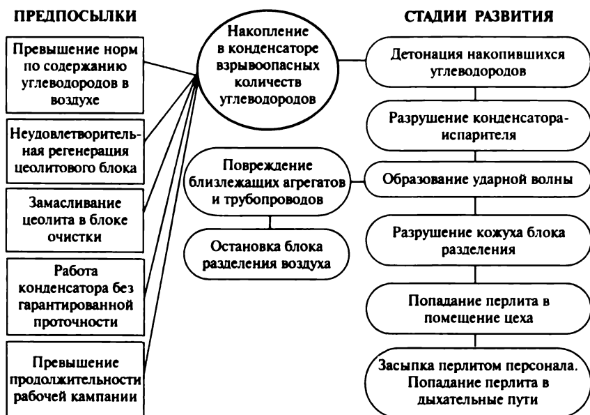
Рис. 20. Сценарий взрыва в конденсаторе-испарителе
