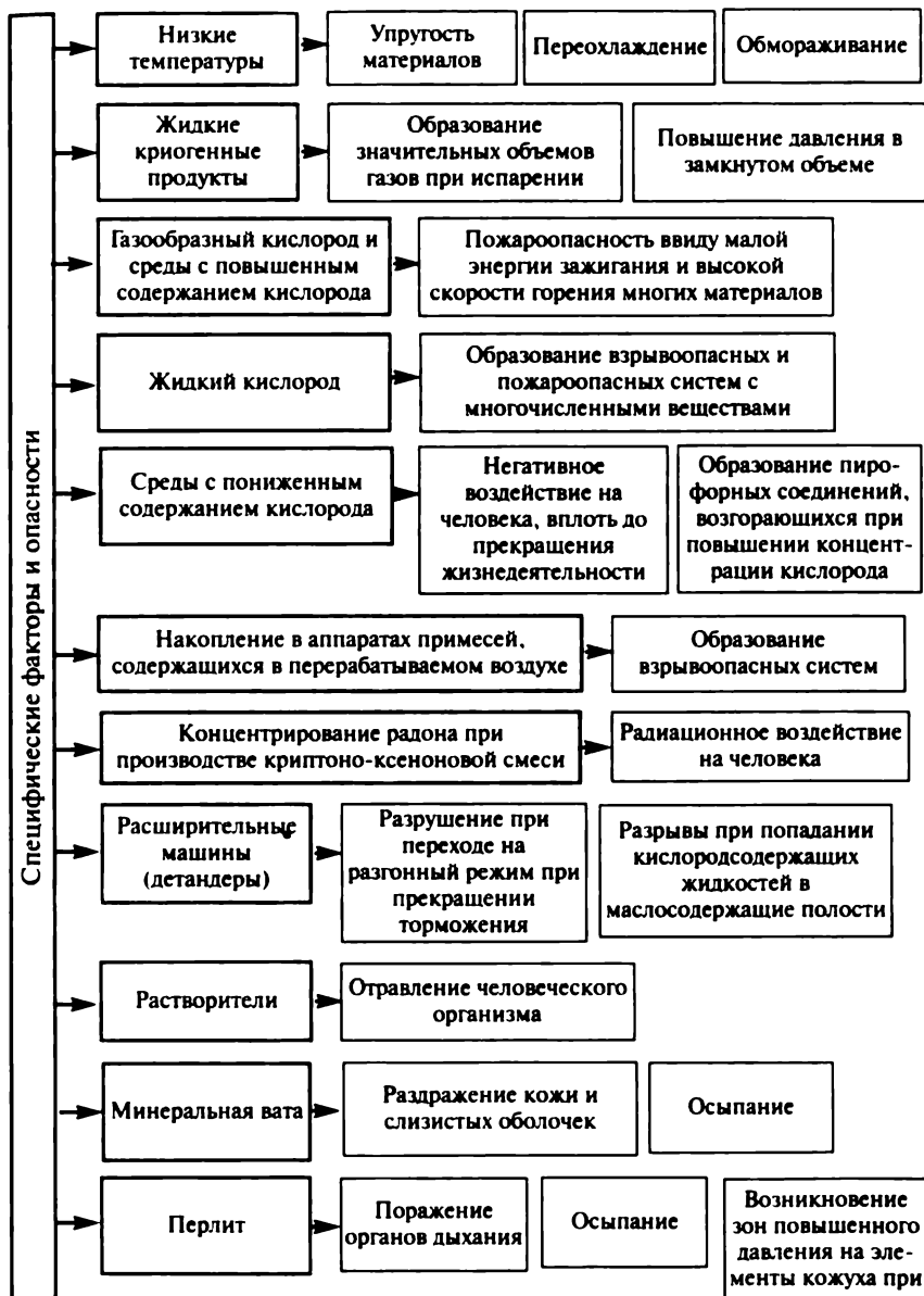
Рис. 1. Специфические факторы и опасности при производстве и потреблении продуктов разделения воздуха
