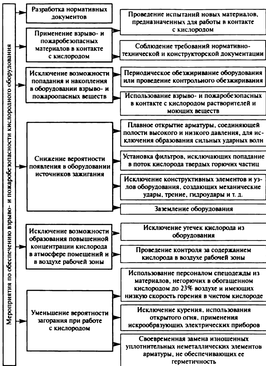
Рис. 2. Мероприятия, выполняемые для обеспечения взрывопожаробезопасности кислородного оборудования
