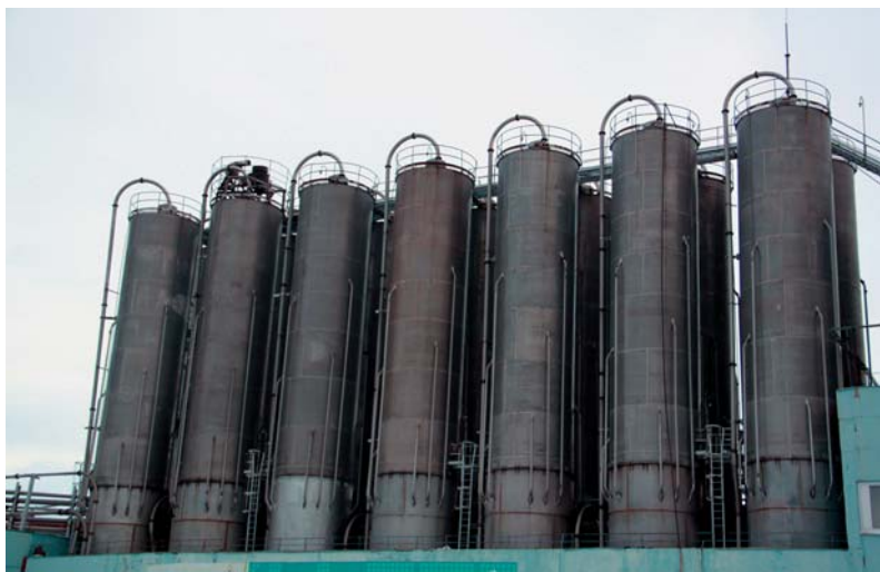
Рис 62. 14 гомогенизаторов установки гранулирования полипропилена смонтированы в 2 ряда
