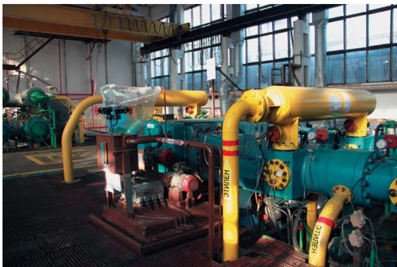
Рис. 50. Этиленовый компрессор
