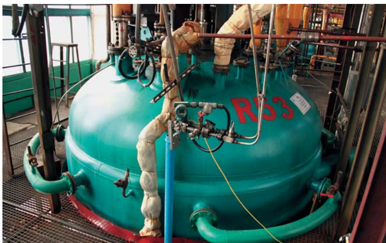
Рис 59–60. Реактор полимеризации пропилена. Доступ к верхней части (вверху) и основанию (внизу) осуществляется с разных этажей цеха
