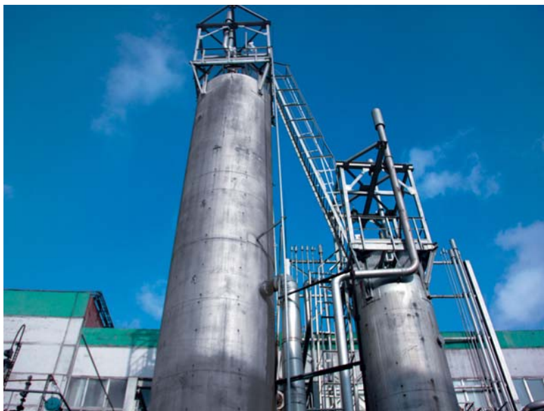
Рис. 49. Ресиверы на производстве ПЭВД. На заднем плане — здание цеха компримирования этилена
