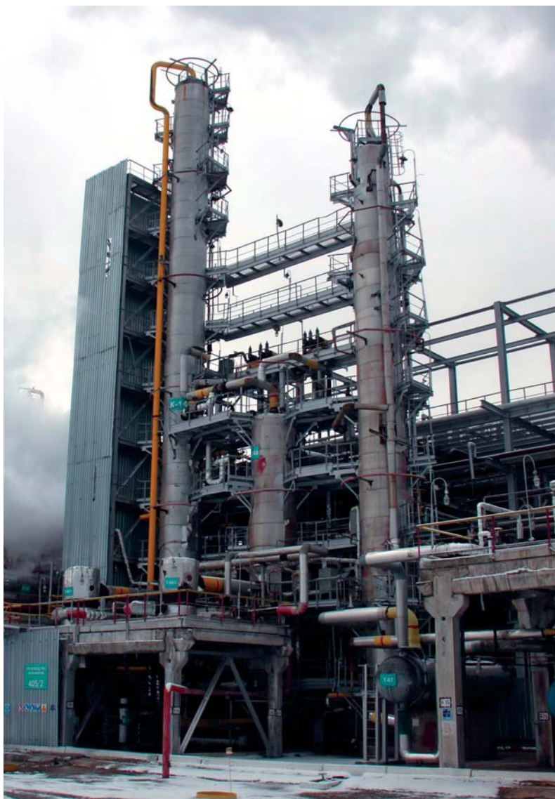
Рис. 48. Слева и в центре — каскад выделения пропан-пропиленовой фракции, справа — колонна — вторичный деэтанизатор пропан-пропиленовой фракции
