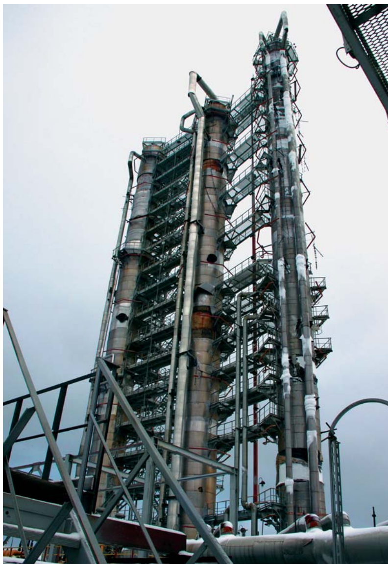
Рис. 46. Слева направо: колонны получения товарного пропилена, колонна получения товарного этилена
