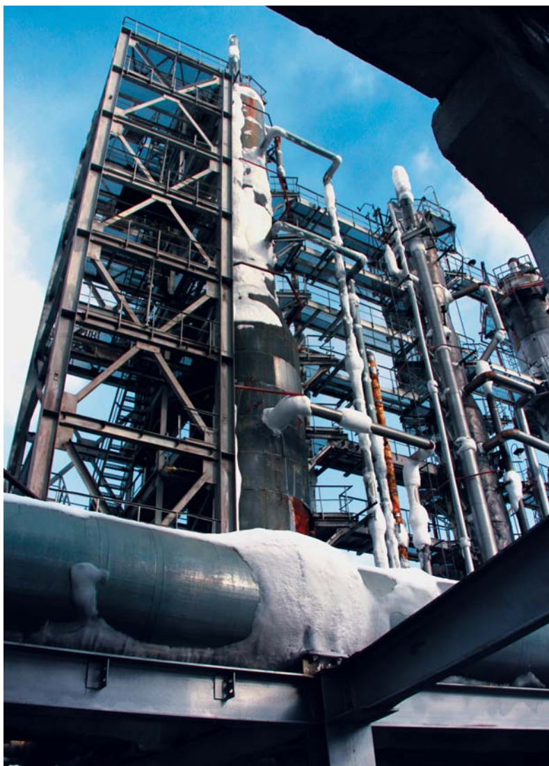
Рис. 44. Колонна-деметанизатор слева. Температура в колонне самая низкая в верхней части и повышается к нижней части. Видны три питающих трубопровода, подающих пирогаз трех разных составов и температур с трех сепараторов на три разных по температуре уровня колонны
