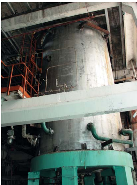
Рис 59–60. Реактор полимеризации пропилена. Доступ к верхней части (вверху) и основанию (внизу) осуществляется с разных этажей цеха
