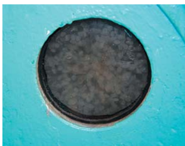
Рис. 53–54. Вверху — аппарат грануляции полиэтилена. Хорошо виден теплоизолирующий кожух электродвигателя. Внизу — гранулы полиэтилена после нарезки
