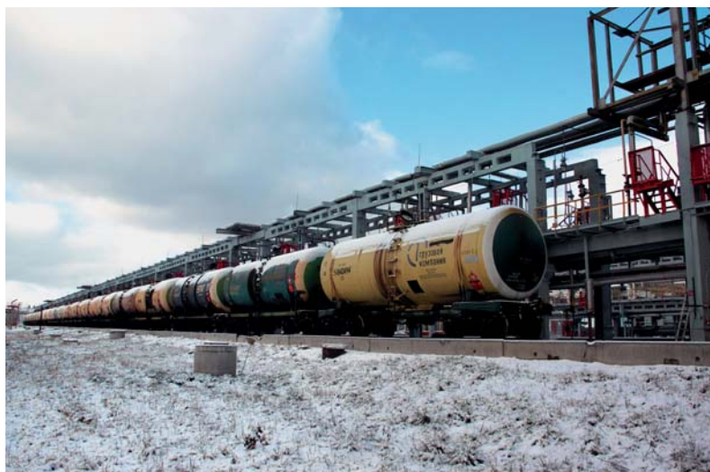
Рис. 30. Цистерны с бензином на железнодорожной эстакаде
