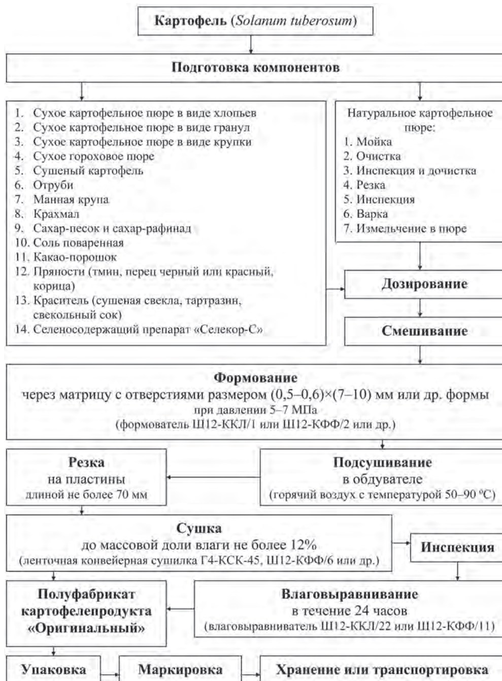
Рис. 5. Технологическая схема производства полуфабриката картофелепродукта «Оригинальный»
