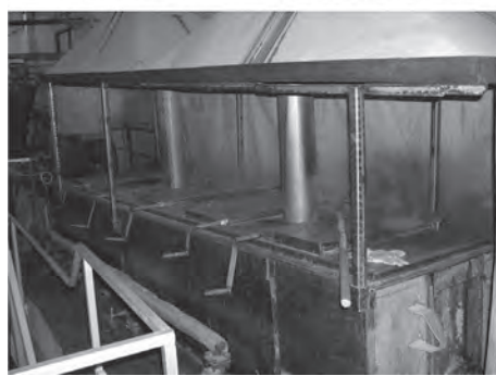
Рис. 3. Современная технология производства сухого картофельного пюре (ОАО «Машпищепрод»): а – мойка; б – очистка; в – инспекция; г – транспортировка на конвейере и элеваторе резанного картофеля; д – бланшировка; е – охлаждение; ж – варка; з – картофелемялка и вальцовая сушилка
