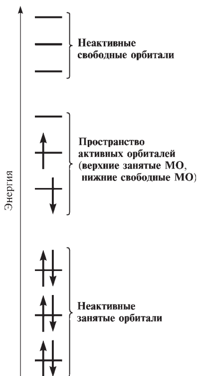
Рис. 3.9. Схема разделения пространства орбиталей на активную и неактивную части
