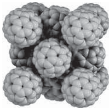
Рис. 7.5. Структура кристалла фуллерита
