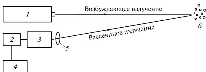
Рис. 10.51. Блок-схема установки дистанционного детектирования загрязняющих веществ в атмосфере:
