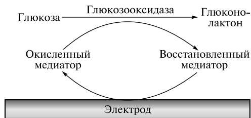
Рис. 15.7. Схема биосенсора второго поколения
