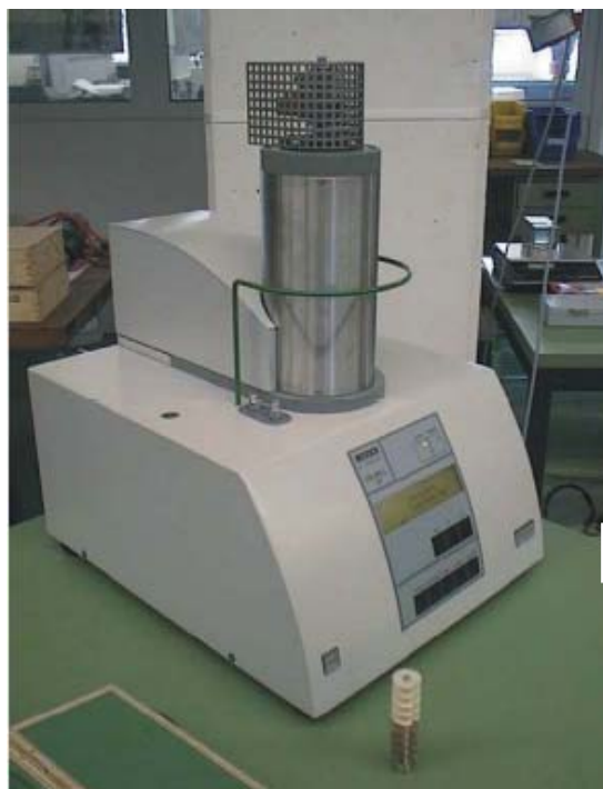
Рис. 3.2. Схема установки для изучения кинетики окисления: а – внешний вид; б – принципиальная схема
