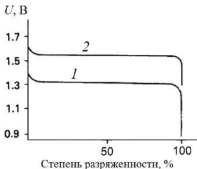
Рис. 2.7. Кривые разряда ртутно-цинкового (1) и серебряно-цинкового (2) первичных элементов
