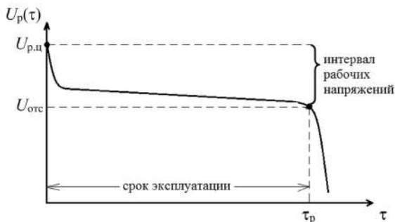
Рис. 1.10. Разрядная кривая и характеристики разряда первичного и вторичного электрохимического элемента при I = \text{const}
