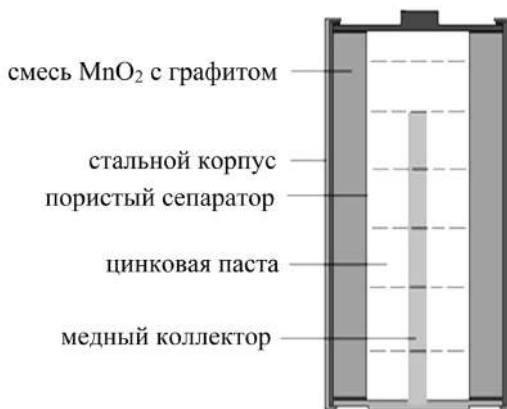
Рис. 2.4. Схема щелочного марганцево-цинкового элемента
