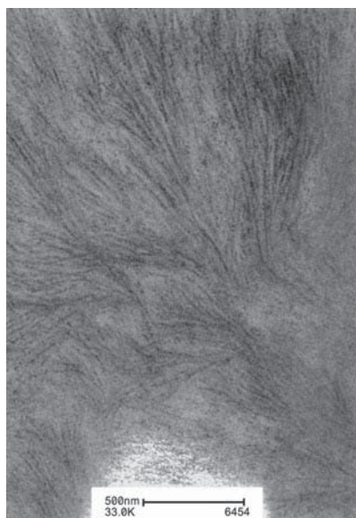
Рис. 14.23, c. Ламеллярная морфология смеси 30/70 ПА-46–ПА-61, подвергнутой литью под давлением с последующим отжигом при 200 °С в течение 10 мин
