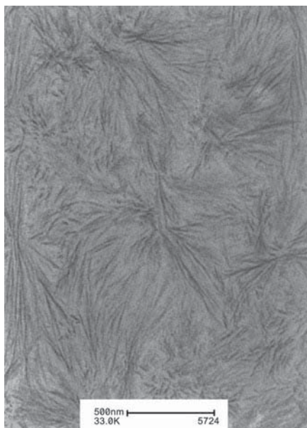
Рис. 14.23, d. Ламеллярная морфология смеси 15/85 ПА-46–ПА-61, подвергнутой литью под давлением с последующим отжигом при 200 °С в течение 10 мин [58]
