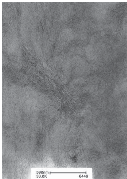
Рис. 14.23, b. Ламеллярная морфология смеси 50/50 ПА-46–ПА-61, подвергнутой литью под давлением с последующим отжигом при 200 °С в течение 10 мин
