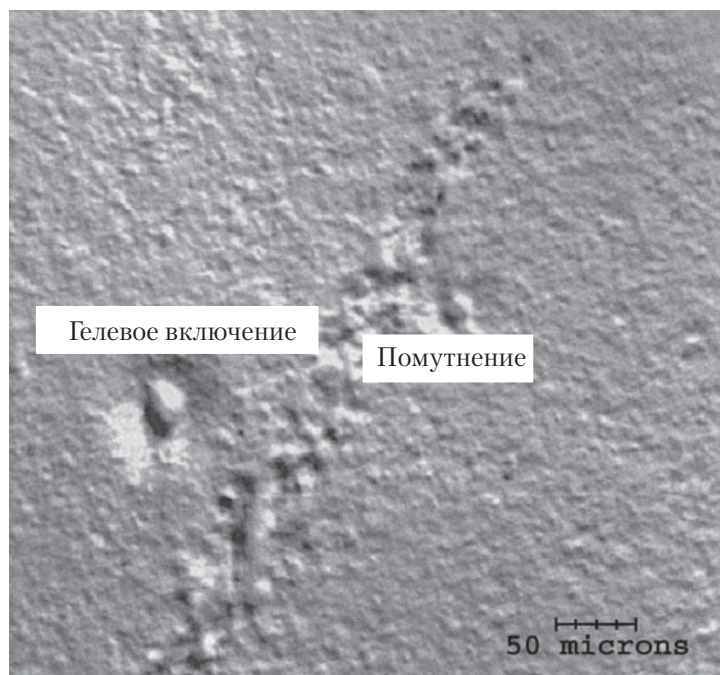
Рис. 9.21. Микрофотография СЭМ, демонстрирующая «углубление» и «помутнение» на поверхности смеси ПК–ПБТ, полученной литьем под давлением
