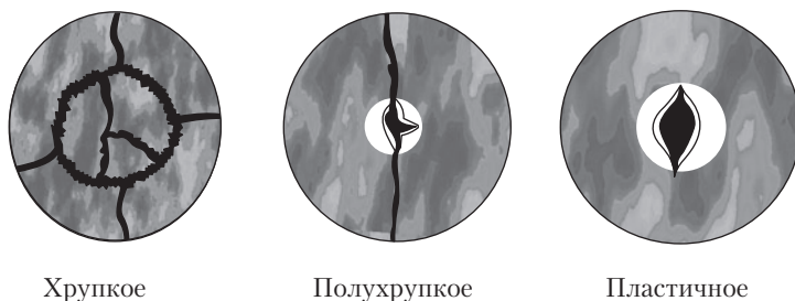
Рис. 21.6. Схематическая диаграмма внешнего вида дисков, подвергнутых ударным испытаниям с заостренным и проявляющим хрупкое, полухрупкое и пластичное разрушение
