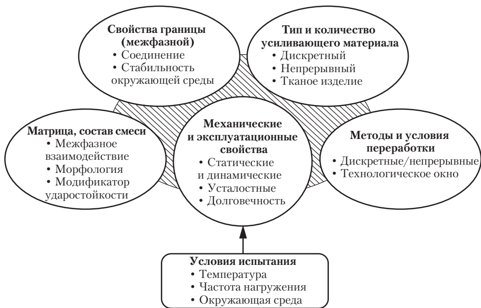
Рис. 31.1. Факторы, влияющие на механические характеристики усиленных полимерных смесей
