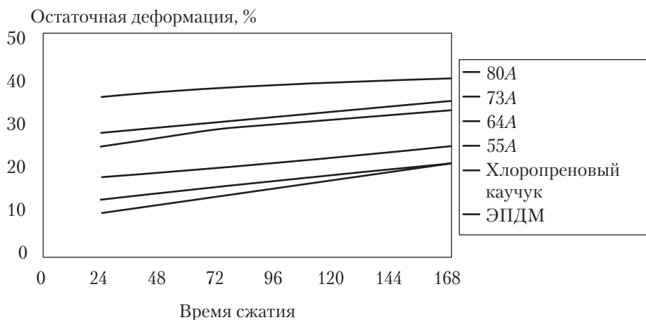
Рис. 35.14. Сопротивление остаточной деформации для ТПВ и эластомеров. Временная зависимость при 100 °C
