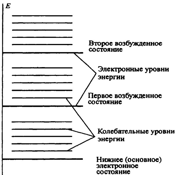
Рис. 4.1. Схематическое расположение электронно-колебательных уровней энергии многоатомной молекулы
