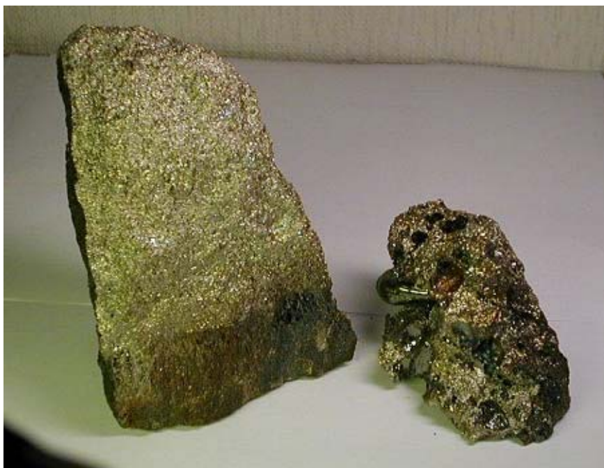
Рис. 41. Образцы феррохрома, выплавленного в печи РКЗ-2ФС-Н1
