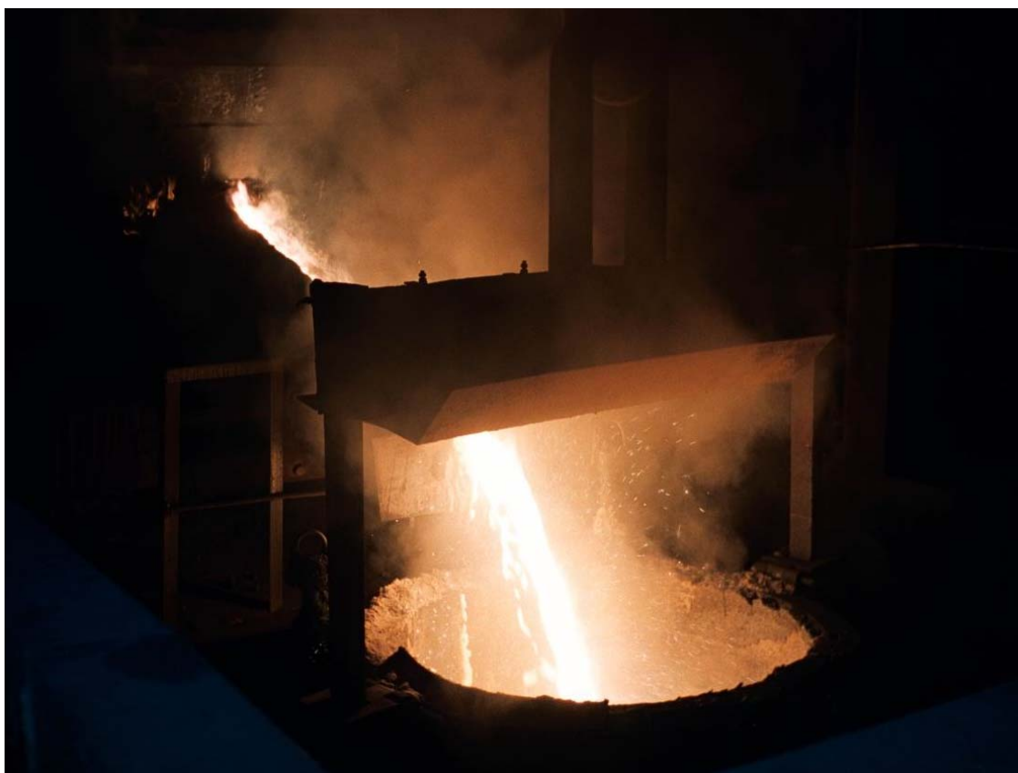
Рис. 73. Выпуск феррохрома в сталеразливочный ковш 29 августа 2000 г.
