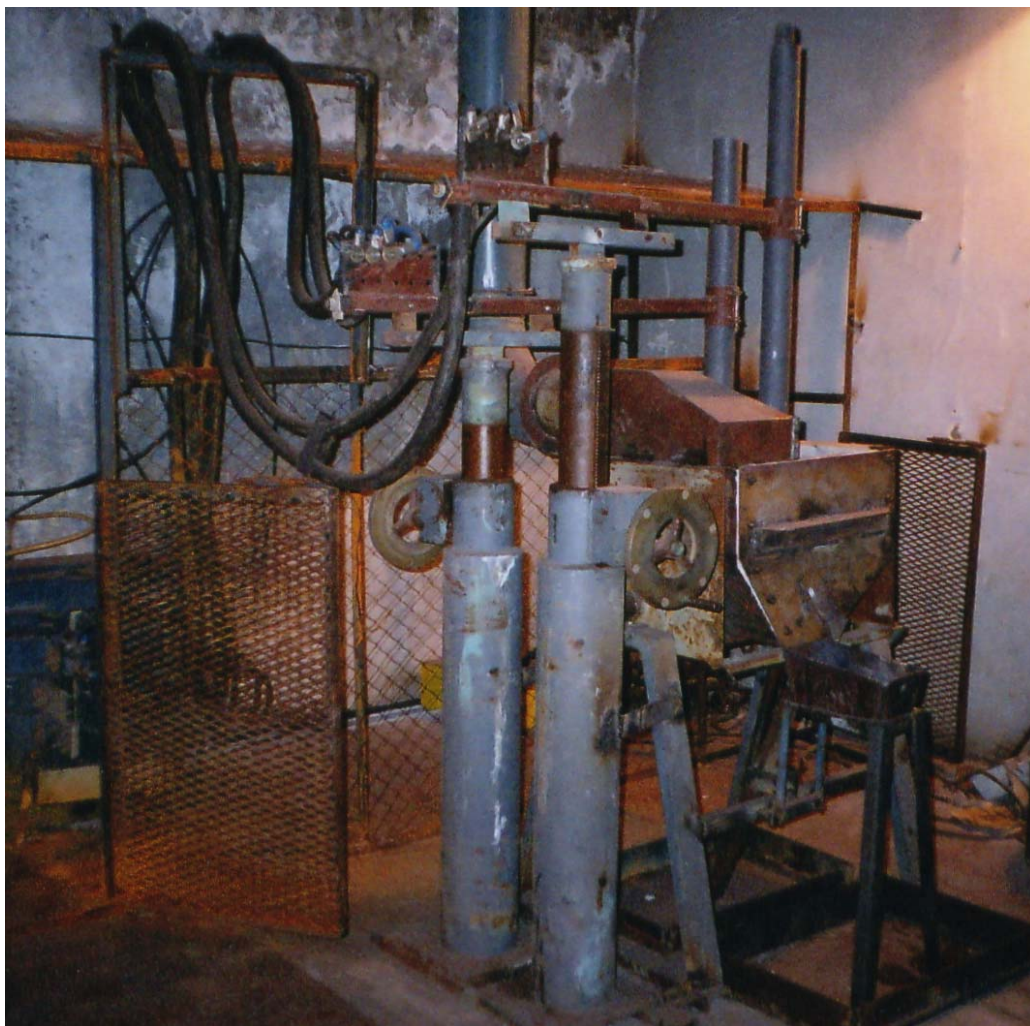
Рис. 28. Опытная руднотермическая печь [183] на пирометаллургическом участке.
