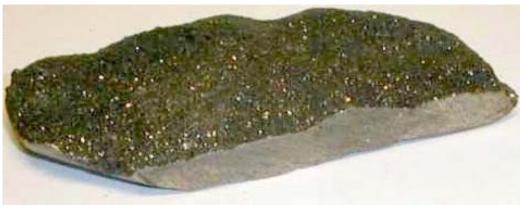
Рис. 51. Слиток ниобийсодержащего сплава, полученного восстановлением ниобиевого концентрата из расплава плавикового шпата в руднотермической печи
