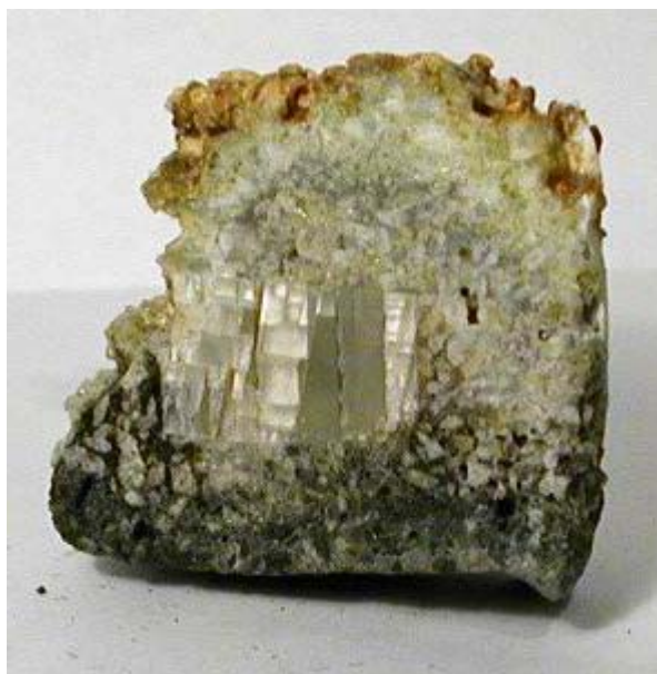
Рис.14. Оксид магния MgO , спеченный из гранул при температуре 1150\text{ }^{\circ}C . В центре кубический кристалл периклаза в натуральную величину.
