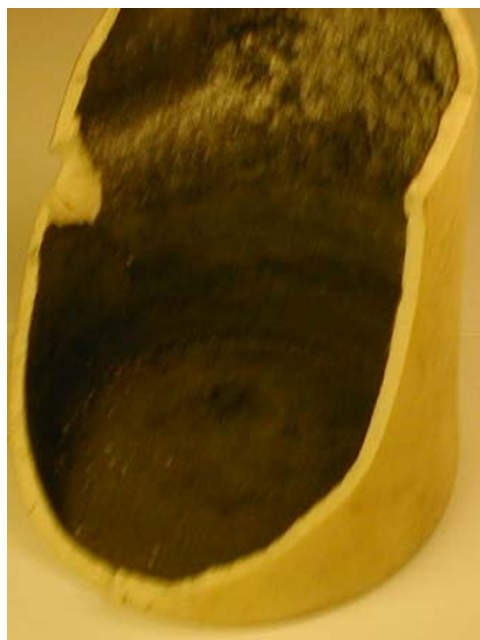
Рис.3 Внутренняя поверхность фарфорового стакана, почерневшая от контакта с водородом.
