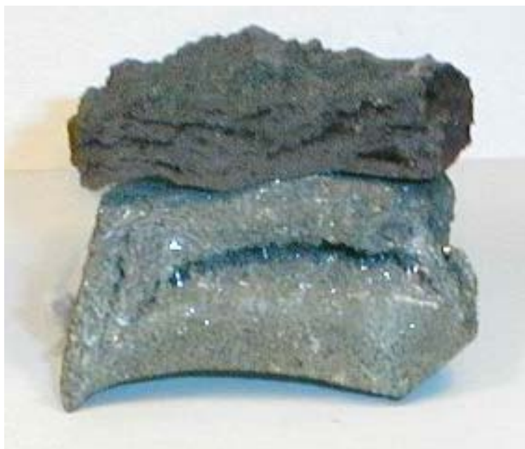
Рис.6 Сегрегация диоксида молибдена от нерудной фазы при восстановлении молибденового огарка.
