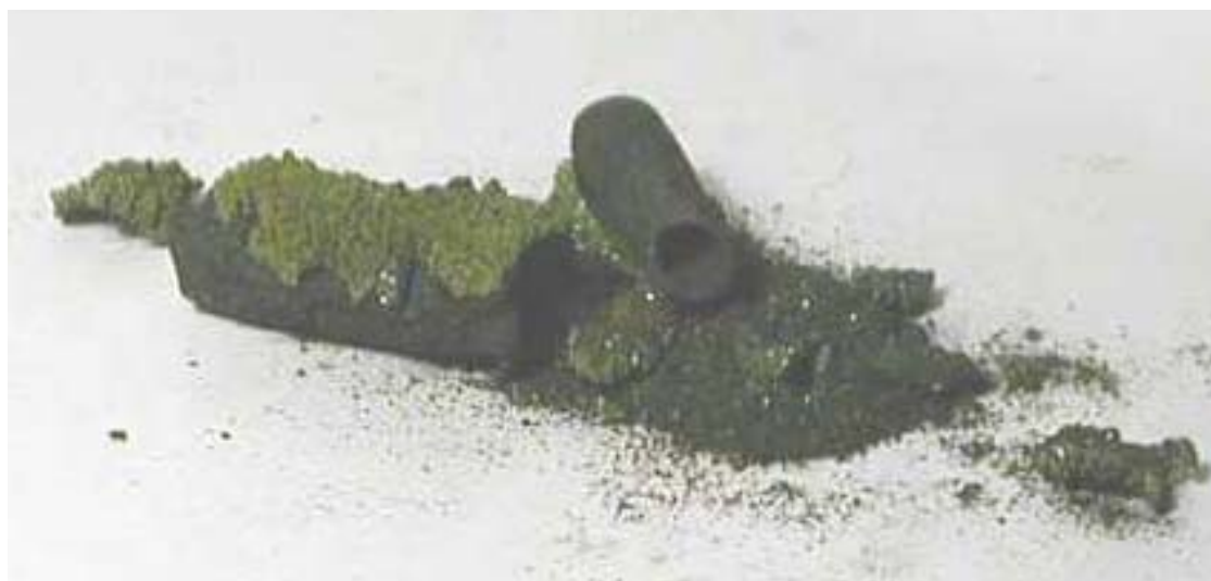
Рис. 2 Кубический карбид кремния (зеленый), полученный путем газофазного осаждения на графитовом нагревателе.
