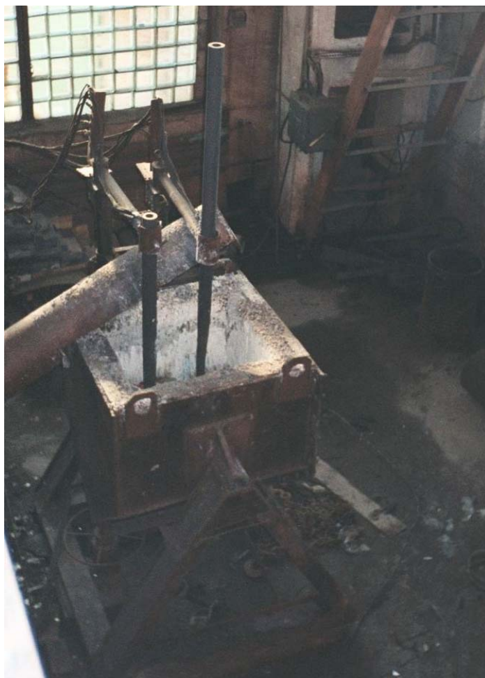
Рис. 49. Укрупненная опытная рудотермическая печь для плавки отсеков солевого шлака
