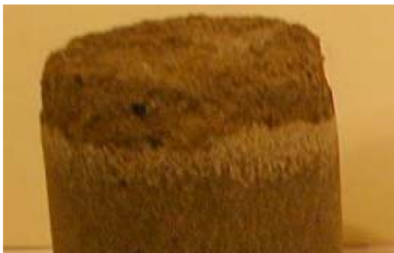
Рис. 5 Сегрегация диоксида вольфрама от нерудной фазы при восстановлении шеелитового концентрата.
