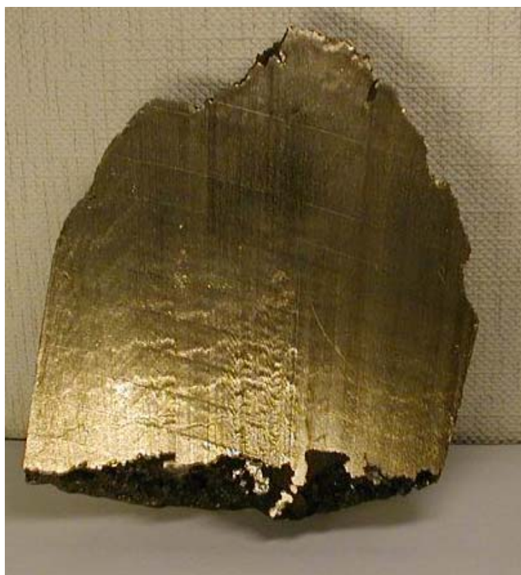
Рис. 31. Образец ферроникеля, восстановленного в опытной руднотермической печи из раствора никелевого огарка в расплаве плавикового шпата.
