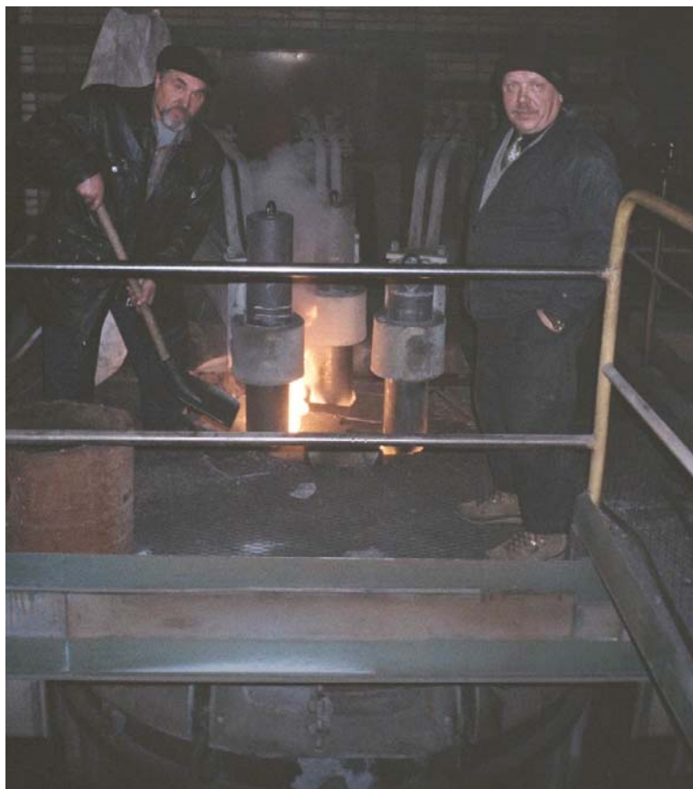
Рис. 33. Загрузка марганцевого концентрата в руднотермическую печь РКЗ-2ФС-Н1
