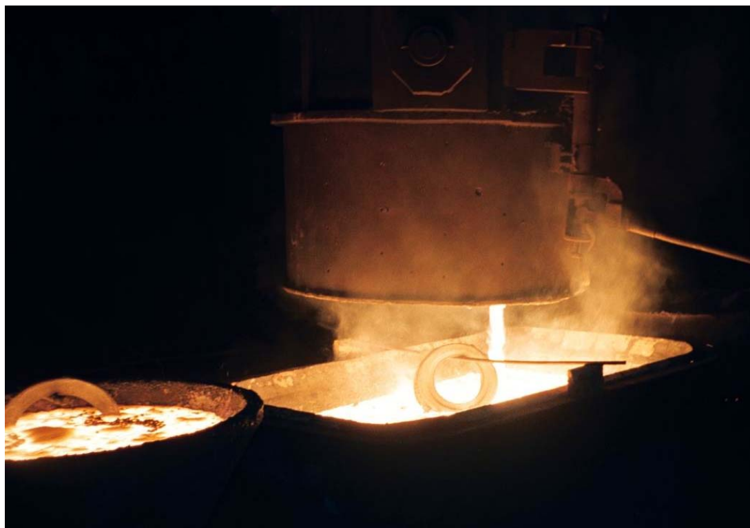
Рис. 74. Разливка феррохрома из ковша по изложницам 29 августа 2000 г.
