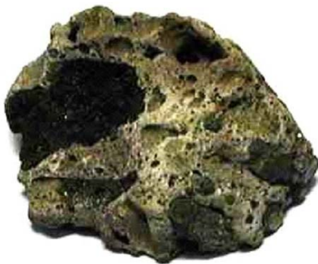
Рис. 46. Образец шлака на основе плавикового шпата, полученный при быстром охлаждении плавки. Черные пятна – древесный уголь, светлые точки – корольки сплава.
