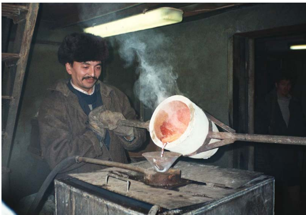
Рис. 55. Заливка жидкого золотосеребряного сплава в устройство для диспергации в плавильном отделении ЗАО НПФ «Башкирская золотодобывающая компания» (1998 г)
