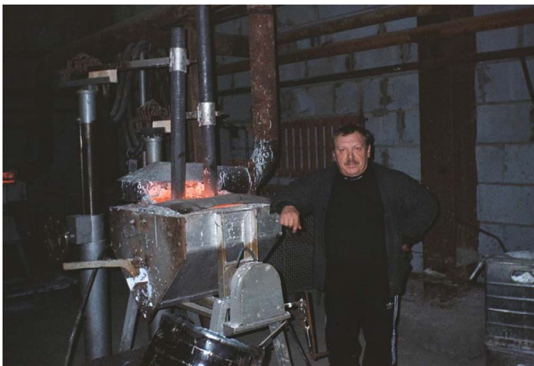
Рис. 58. Плавильное отделение ЗАО «Золото Северного Урала», оборудованное четырьмя руднотермическими печами для плавки цинкового цементата (2000 г).
