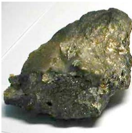
Рис. 47. Образец феррохрома, выплавленный с использованием криолита.
