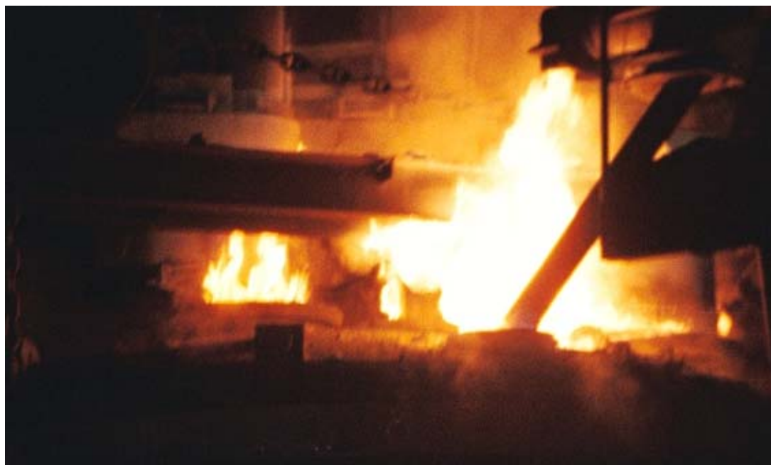
Рис. 20. При восстановлении хромовой руды из расплава плавикового шпата пламя горящего оксида углерода выбивается из ванны печи через экономайзеры в газоход.
