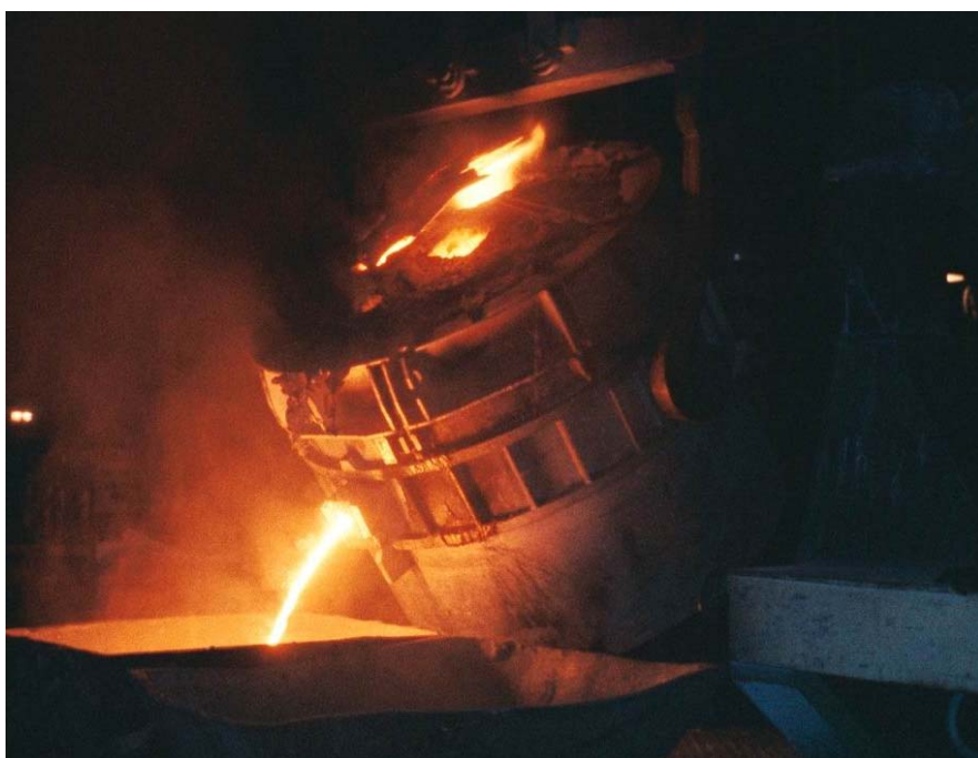
Рис. 34. Выпуск шлака плавки ферромарганца из печи РКЗ-2ФС-Н1
