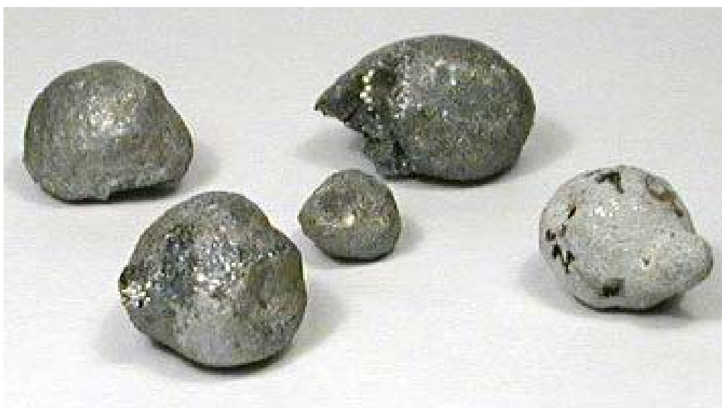
Рис. 50. Корольки силумина, полученного восстановлением оксидов кремния и алюминия из расплава криолита в руднотермической печи
