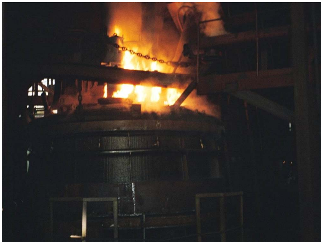
Рис. 69. Водоорошаемый кожух руднотермической печи в процессе восстановления хромовой руды. Отчетливо видно пламя горящего оксида углерода.
