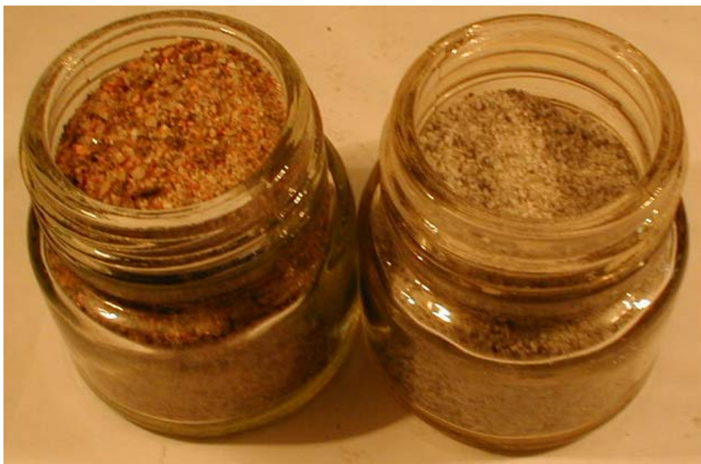
Рис. 13. Образцы речного кварцевого песка. Слева – загрязненный оксидами железа, справа – очищенный от оксидов железа.
