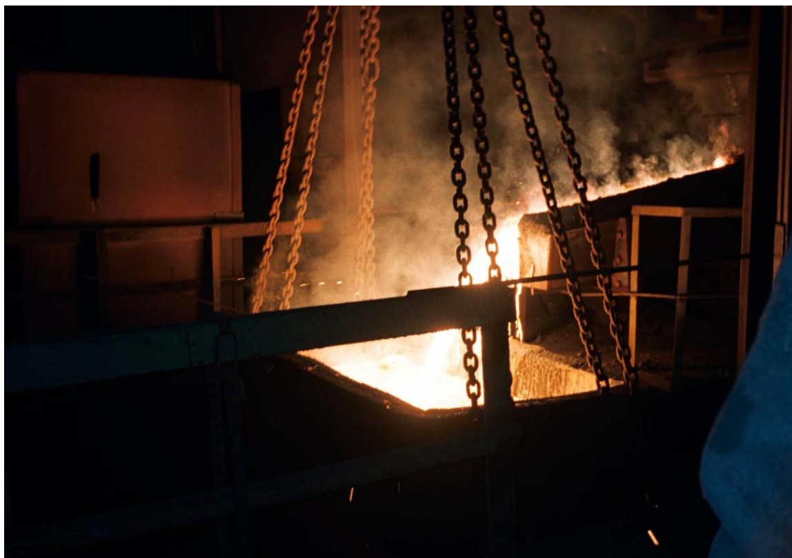
Рис. 72. Выпуск шлака плавки феррохрома в шлаковню 29 августа 2000 г.
