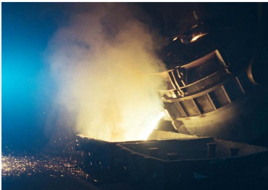
Рис. 35. Выпуск ферромарганца из печи РКЗ-2ФС-Н1
