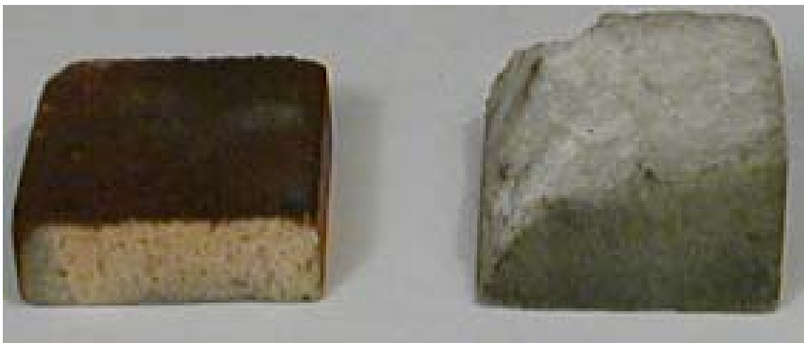
Рис. 11. Образцы плавленного оксида магния (периклаза). Слева – загрязненный оксидами железа, справа – очищенный от оксидов железа.
