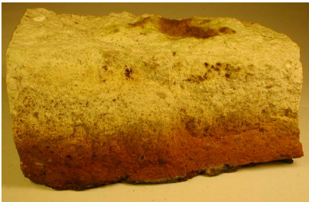
Рис. 10. Образец магнезиального огнеупорного кирпича, частично очищенный от оксидов железа (белый цвет).
