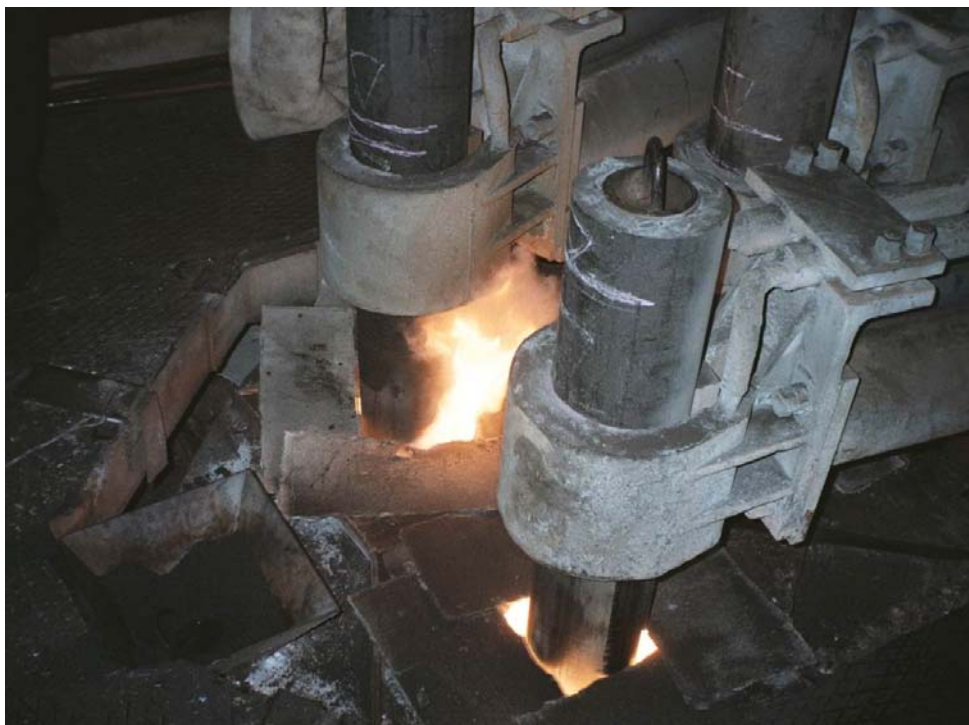
Рис. 40. Подача кокса через загрузочное окно в печь РКЗ-2ФС-Н1 сопровождается восстановлением, что фиксируется по горению оксида углерода над ванной печи.
