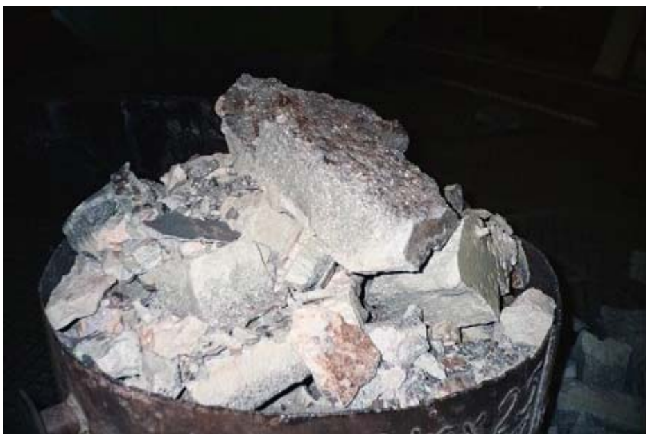
Рис. 42. Шлак плавки феррохрома в печи РКЗ-2ФС-Н1
