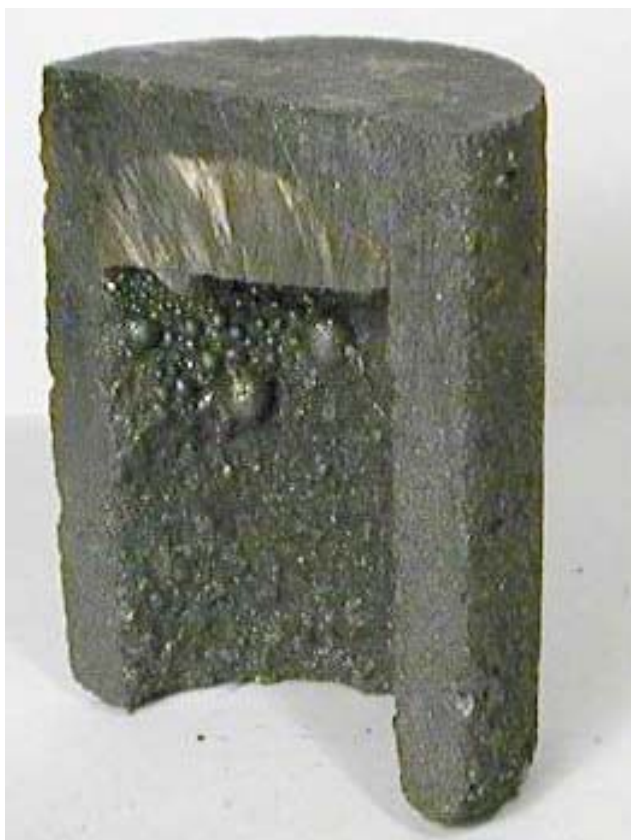
Рис.4 Компакт-слиток и корольки железа на внутренней поверхности графитового тигля.
