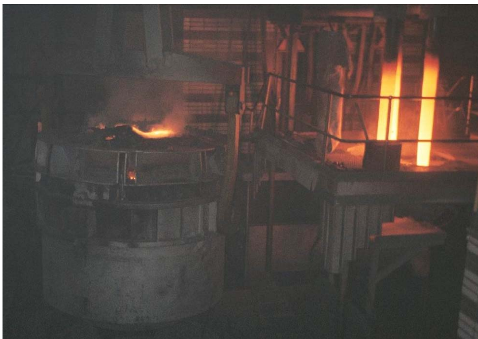
Рис. 32. Руднотермическая печь РКЗ-2ФС-Н1 с выкатной ванной
