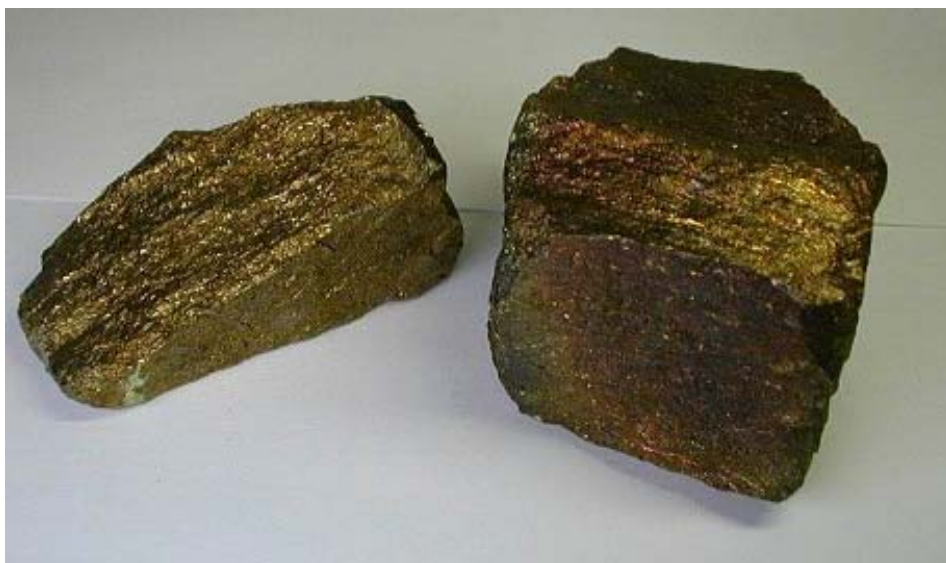
Рис. 37. Образцы ферромарганца, выплавленного в печи РКЗ-2ФС-Н1
