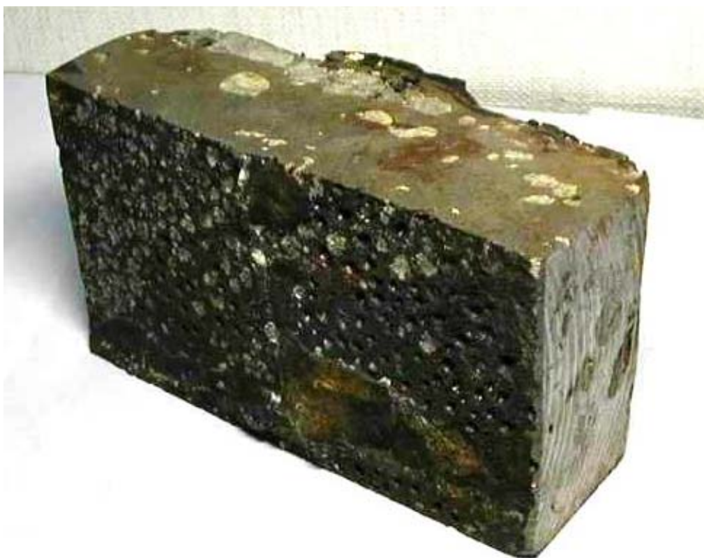
Рис. 30. Образец железа, восстановленного из раствора железной руды в расплаве плавикового шпата в гарниссажной ванне дуговой электропечи ДС–6Н1.
