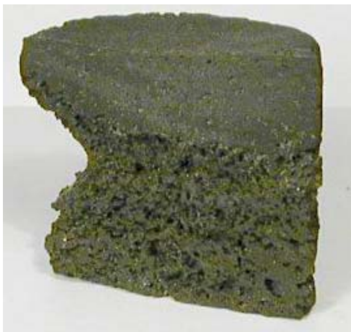
Рис.9. Сегрегация металлизированной фазы от кремнезема при восстановлении железистых кварцитов КМА.
