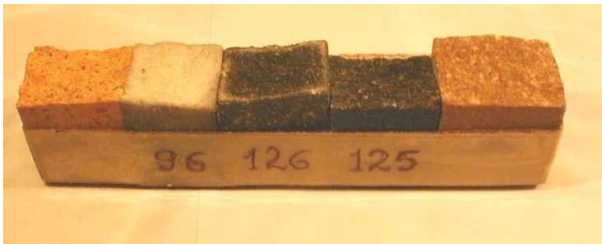
Рис. 12. Образцы плавленного оксида магния (периклаза) после прямого восстановления при различных температурах.
