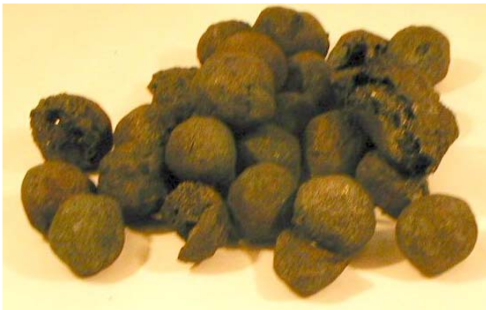
Рис. 8. Железорудные окатыши, металлизированные с использованием твердого углеродистого восстановителя в куполообразном нагревательном устройстве.
