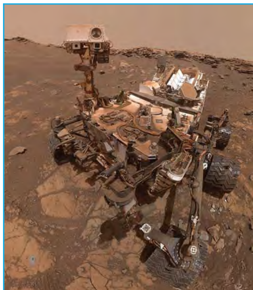
◀ Рис. 8.6. Марсоход Кьюриосити с установленным на борту рентгеновским аппаратом (размер – коробка от обуви). С августа 2012 г. по январь 2017 г. он проехал 15,26 км по поверхности Марса, анализируя минеральный состав горных пород
