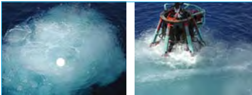
▲ Рис. 4.5. Разложение газовых гидратов при подъеме пробы на поверхность (Атлантический океан, глубина 2000 м)
