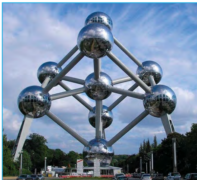
▲ Рис. 3.36. Атомиум – ячейка \alpha -железа ( a = 2.9 \text{ \AA} ) увеличенная в 165 млрд раз. Символ всемирной Брюссельской выставки 1958 г.
