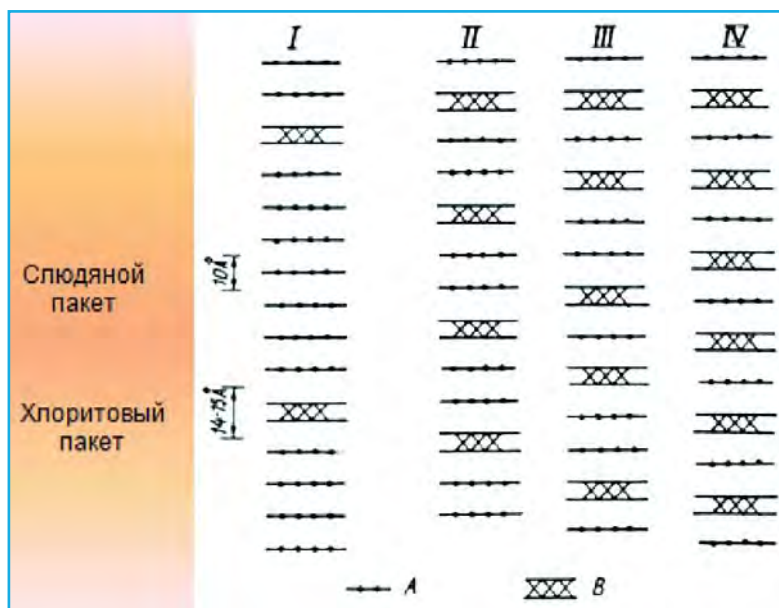
▲ Рис. 8.81. Четыре схемы строения смешанослойных минералов: А – слюдяной пакет, В – хлоритовый пакет
