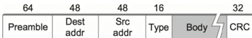
Рисунок 2.21. Формат кадра Ethernet.
