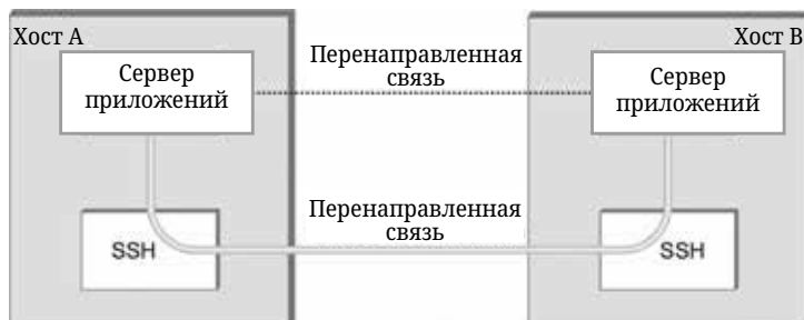
Рисунок 8.14. Использование перенаправления портов SSH для защиты других приложений на базе TCP.
