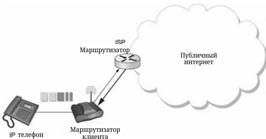
Рисунок 9.11. Дифференцированные услуги, применяемые к приложению VOIP. Очередь DiffServ применяется только на восходящем канале от маршрутизатора клиента к провайдеру.
