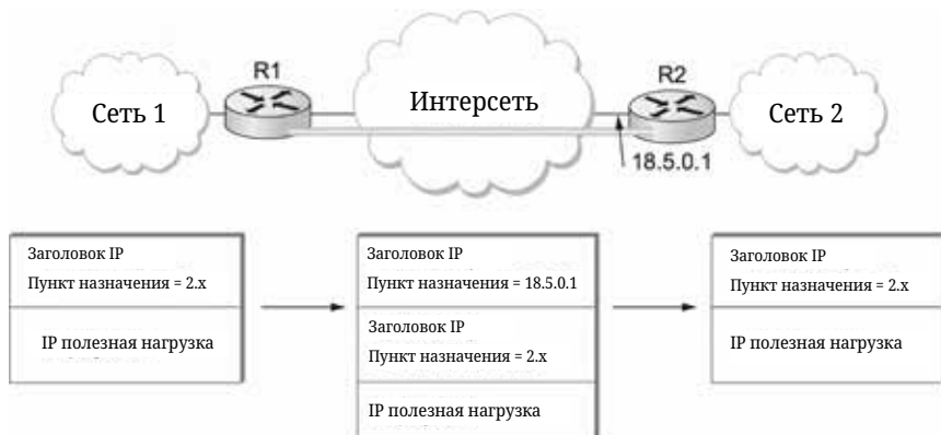
Рисунок 3.28. Туннель через интернет. 18.5.0.1 — это адрес R2, к которому можно обратиться из R1 через интернет-сеть.
