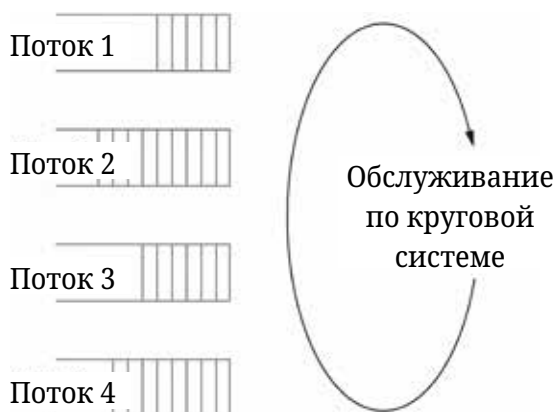
Рисунок 6.6. Обслуживание по круговой системе четырех потоков на маршрутизаторе.
