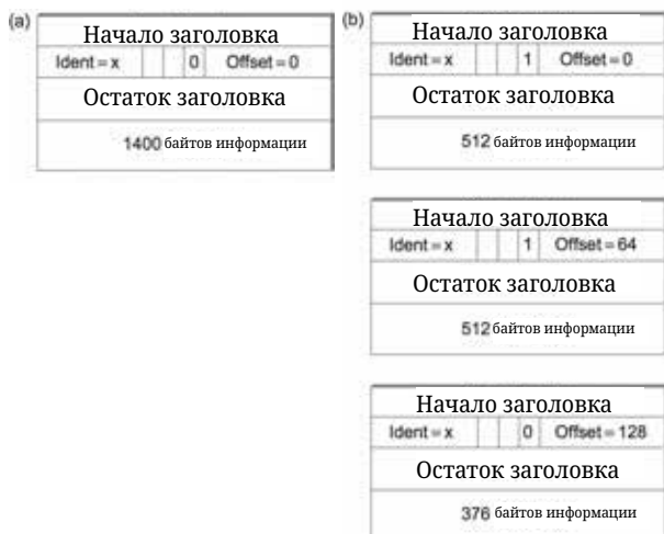
Рисунок 3.19. Поля заголовка, используемые при фрагментации IP: (a) нефрагментированный пакет; (b) фрагментированный пакет.
