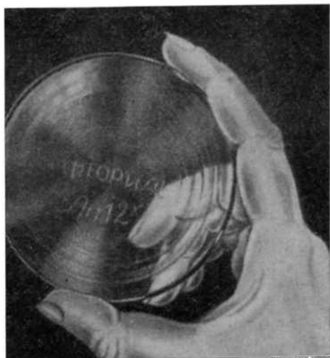
Рис. 20. Реакция травления стекла фтористым водородом.
