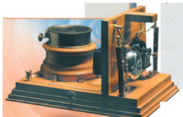
Радиоприёмник А. С. Попова
