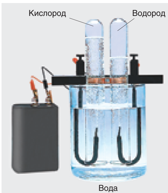
Рис. 6. Образование кислорода и водорода из воды
