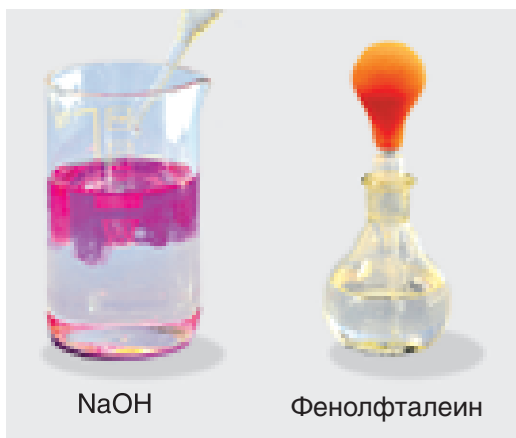
Рис. 78. Окраска фенолфталеина в растворе щёлочи
