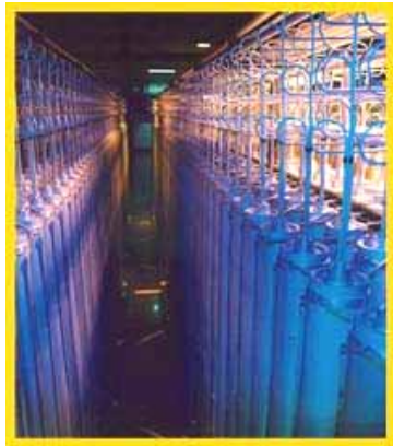
Рис. 208. Каскад центрифуг концерна Urenco.
