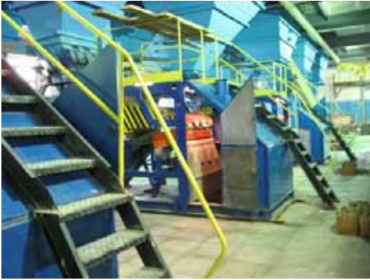
Рис. 172. Рентгенорадиометрический сепаратор на линии сортировки урановых руд ОАО ППХО.
