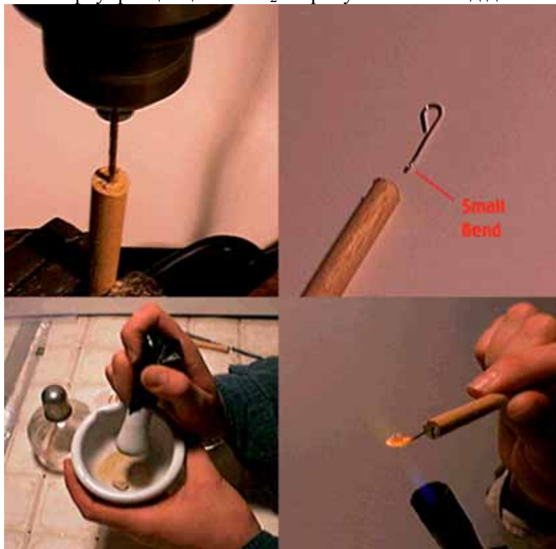
Рис. 37. Последовательность предварительных операций по обнаружению урана (или тория) методом флуоресценции (использование платиновой проволоки и газовой горелки для получения сплава урансодержащего образца со фторидом натрия).
