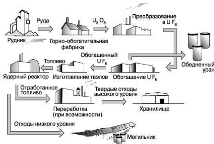
Рис. 165. Переработка урановой руды для оборонной промышленности и энергетики.
