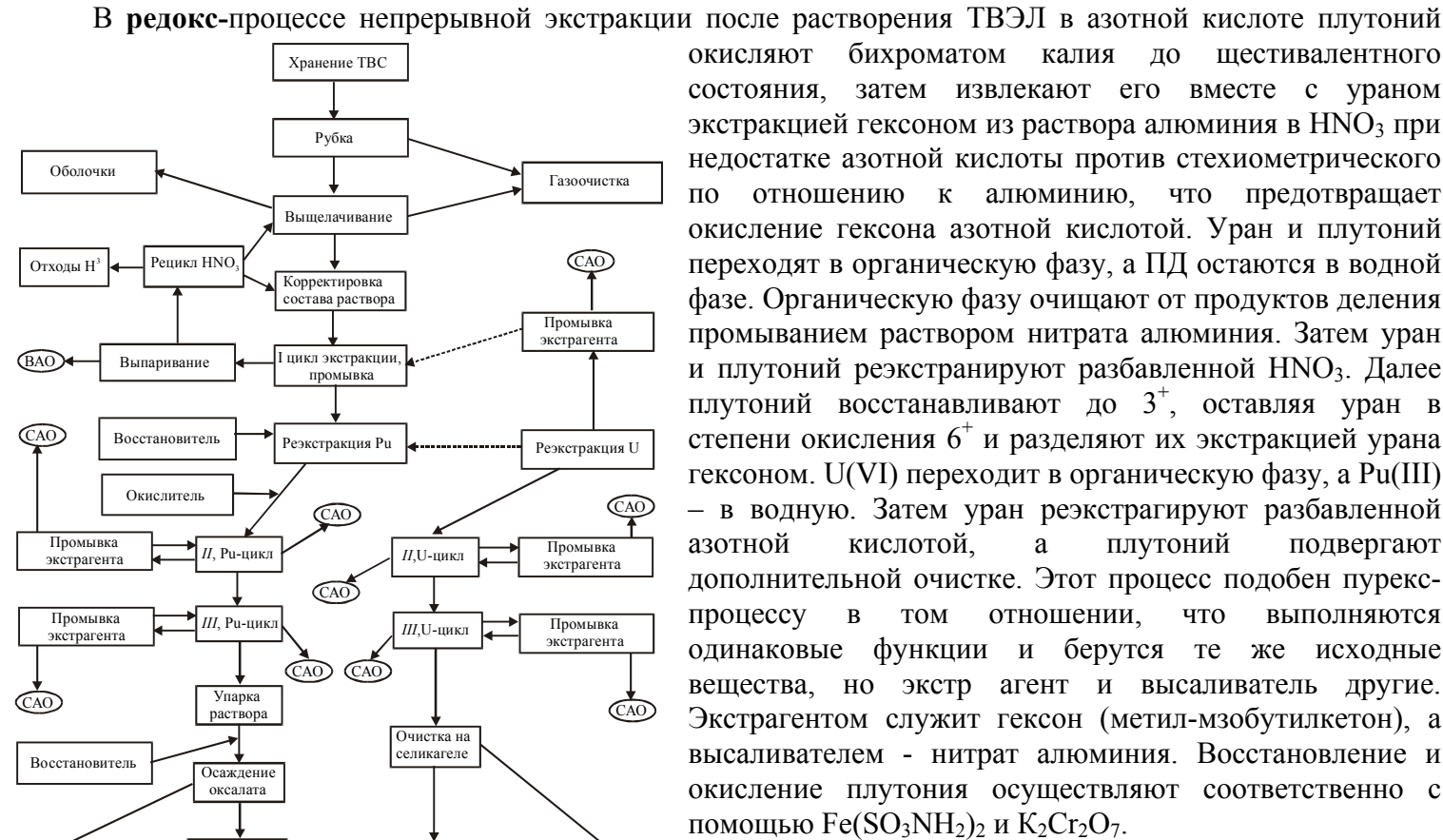
Рис. 268. Типовая водно-экстракционная схема переработки отработанного топлива АЭС. (CAO – среднеактивные отходы BAO - высокоактивные отходы).
