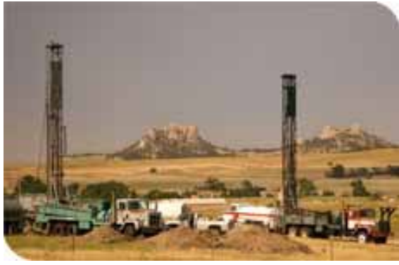
Рис. 152. Щелочное скважинное выщелачивание на урановом руднике, США.
