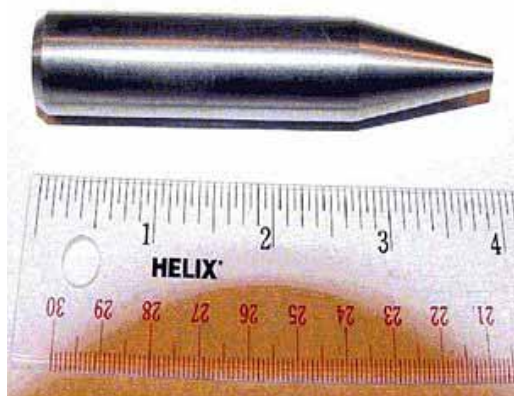
Рис. 46. Наконечник (вкладыш) снаряда калибра 30 мм (пушки GAU-8 самолёта А-10) диаметром около 20 мм из обеднённого урана.
