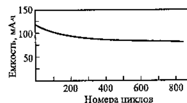
Рис. 4.10.6. Зарядно-разрядные кривые свежеизготовленного элемента с микропористым полимерным электролитом на основе \text{C}/\text{LiMn}_2\text{O}_4 емкостью 0,2 А · ч при токах заряда и разряда 10 мА
