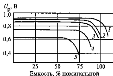
Рис. 2.4.3. Разрядные характеристики элемента РЦ73 при температурах, °C: 50 (1), 20 (2), 0 (3—5) [0.8]. Разрядные токи ( C_{ном} ): 1, 2, 3 — 0,01; 4 — 0,02 и 5 — 0,04
