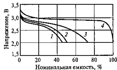
Рис. 4.10.2. Типичные разрядные характеристики цилиндрического аккумулятора типоразмера AA фирмы Tadiran при токе 0,25 А и температурах, °С:
