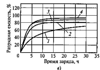
Рис. 4.3.20. Влияние зарядного напряжения на разрядную емкость НК-аккумулятора для типов: Н (а), М (б), L (в). Ограничение нормированного тока 0,2C 5 . Температура от +20 до +25 °C. Напряжение заряда:
