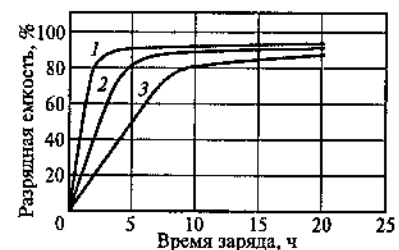
Рис. 4.3.21. Влияние ограничения тока заряда при заряде НК-аккумулятора типа М при постоянном напряжении на время заряда и разрядную емкость. Напряжение заряда 1,5 В; температура от +20 до +25 °C:
