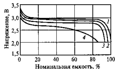
Рис. 4.10.1. Типичные разрядные характеристики цилиндрического аккумулятора типоразмера AA фирмы Tadiran при комнатной температуре и токах, А:
