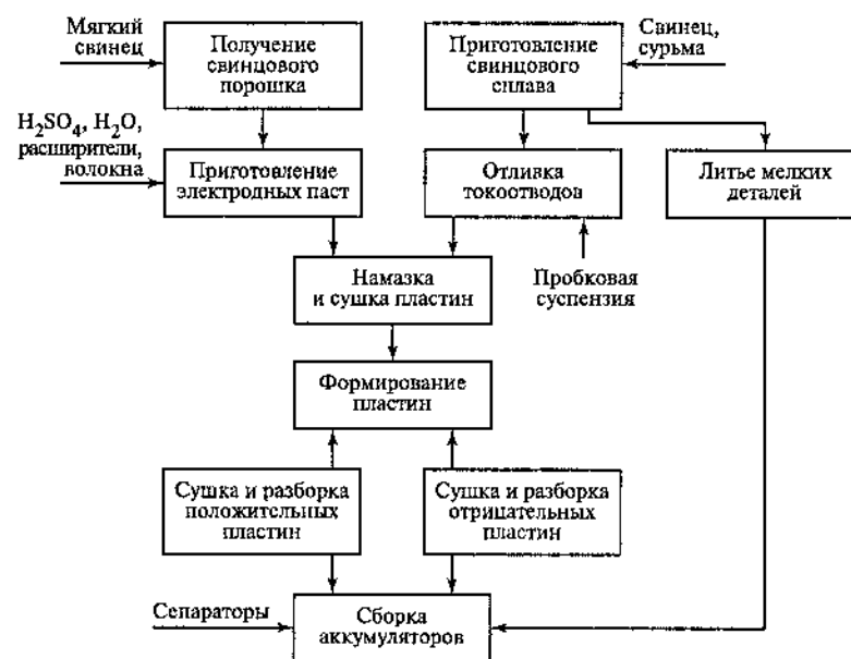
Рис. 4.2.17. Технологическая схема производства сухозаряженных стартерных аккумуляторов
