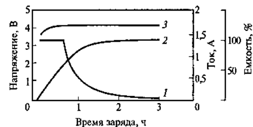
Рис. 4.10.5. Типичный график заряда литий-ионного аккумулятора. Температура комнатная. Постоянный нормированный ток 1С, постоянное напряжение 4,1 В:
