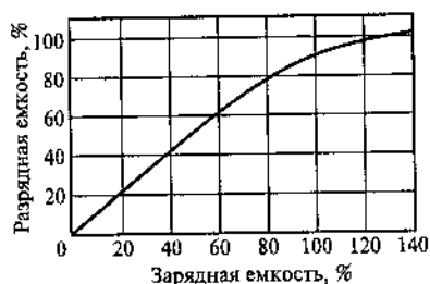
Рис. 4.3.22. Зависимость разрядной емкости НК-аккумулятора от емкости заряда при заряде нормированным постоянным током 0,2C_5
