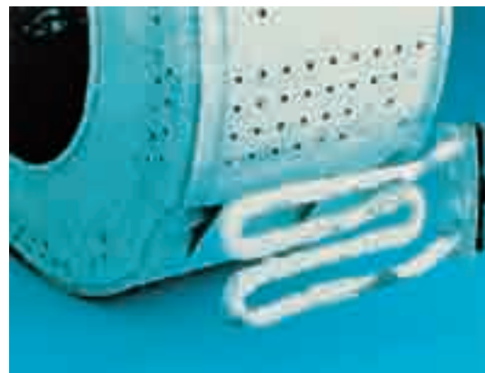
Известковый осадок на нагревательном стержне стиральной машины
