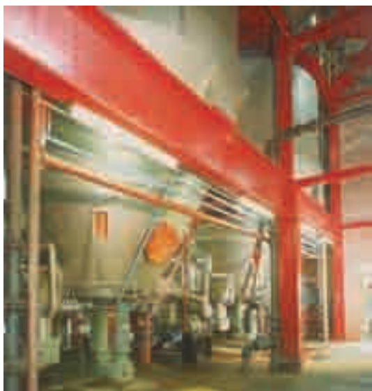
На промышленных предприятиях получение осадка твердой соли происходит в больших кристаллизаторах
