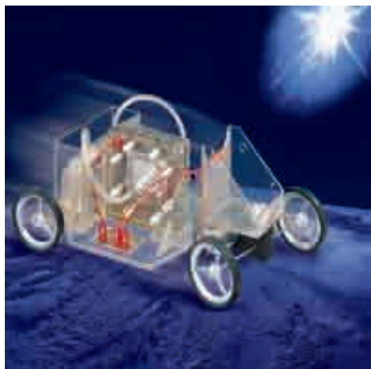
В топливном элементе с водородом в процессе сжигания образуется вода. При этом возникает электрическая энергия
