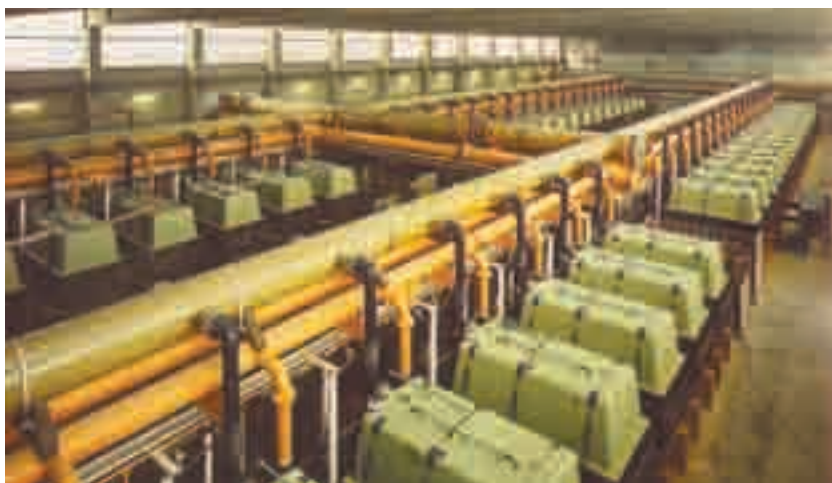
Электролиз раствора хлористого натрия в химической промышленности
