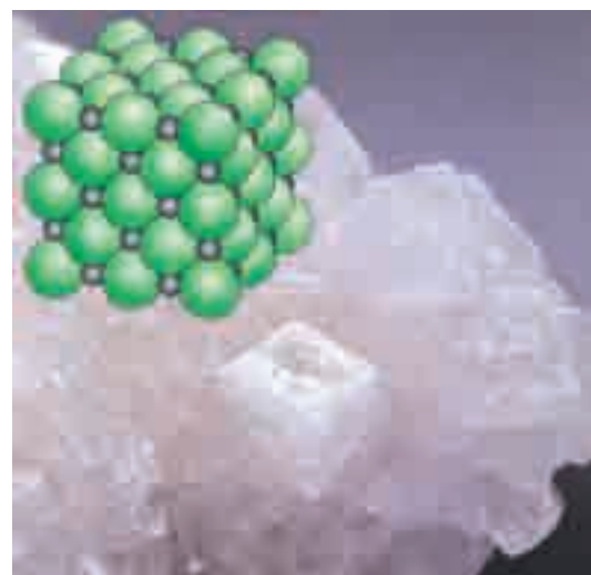
Кристаллы поваренной соли (хлорида натрия). Схема показывает расположение ионов: ионы натрия серые, хлорида — зеленые.
