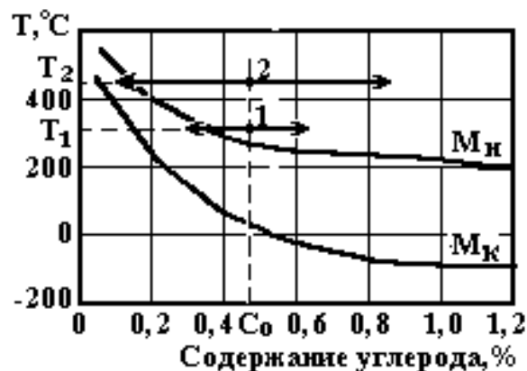
Рисунок 5.6 Схема перераспределения углерода в аустените при температурах бейнитного превращения
