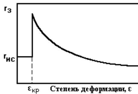
Рисунок 6.7. Влияние степени пластической деформации ( \epsilon ) на размер рекристаллизованного зерна r_z : r_{исх} - исходный до пластической деформации размер зерна; \epsilon_{кр} - критическая степень деформации
