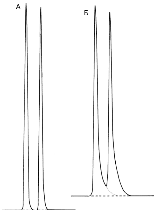
Рис. 2.7. (А) Два пика хорошо разрешены на высококачественной колонке. Для упрощения восприятия нулевая линия под пиками показана пунктиром. (Б) Аналогичное разделение на той же колонке после длительного использования. Пики на хроматограмме (Б) несколько ниже, но их площади те же. Истинная форма среза первого пика показана пунктирной линией.
