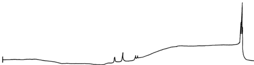
Рис. 3.13. Пик в конце хроматографического опыта – пик на обратном градиенте. Он имеет место, когда состав подвижной фазы начинает возвращаться к исходному. Это явление встречается почти исключительно в смесях ацетонитрила с водой.
