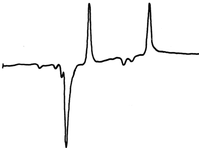
Рис. 3.48. Положительные и отрицательные пики и изменения интенсивности на полученной на рефрактометрическом детекторе хроматограмме сложной смеси жирной кислоты, холестерина и сфинганина. Положительные и отрицательные пики обусловлены анализируемыми веществами и допускают количественное определение.
