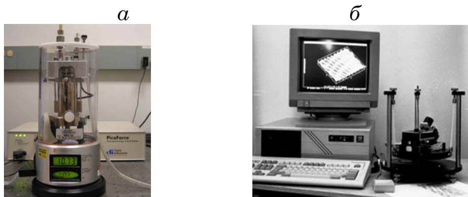
Рисунок 2.3. Два основных типа сканирующих зондовых микроскопов: а – одна из последних моделей атомно-силового микроскопа, б – одна из первых моделей отечественного сканирующего туннельного микроскопа STM-4 (1993 г.).
