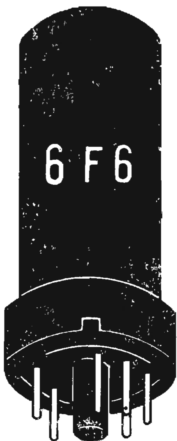
Рис. 60. Низкочастотный пентод типа 6Ф6.
