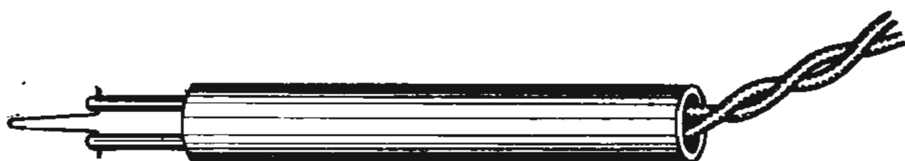
Рис. 140. Электрический карандаш из эбонитовой трубки.
