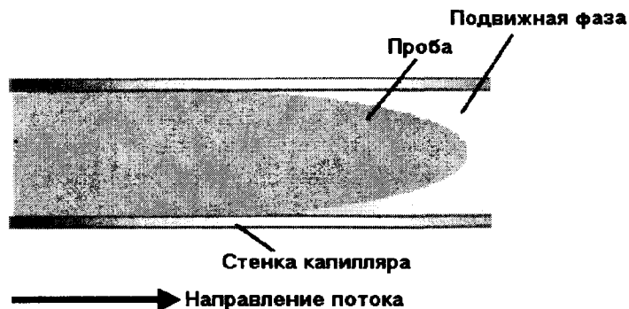
Рис. 3.3. Профиль потока пробы в петле инжектора
