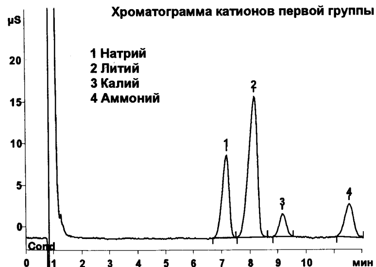
Рис.1.13. Разделение катионов 1-ой группы на колонке Аквилан С1Р 150х4.6мм, элюент: 4 мМ р-р азотной кислоты, скорость потока 1.5 мл/мин; кондуктометрический детектор без подавления 1 – натрий; 2 – литий; 3 – калий; 4 – аммоний
