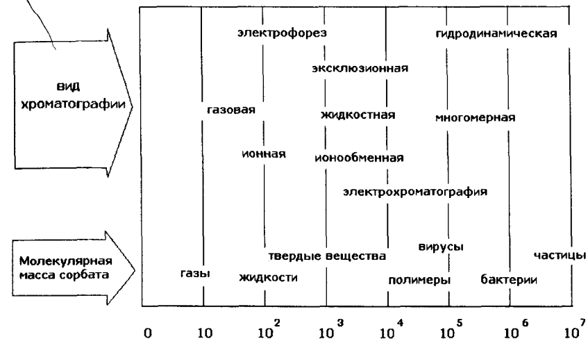
Рис.1.4. Области применения различных вариантов хроматографического метода
