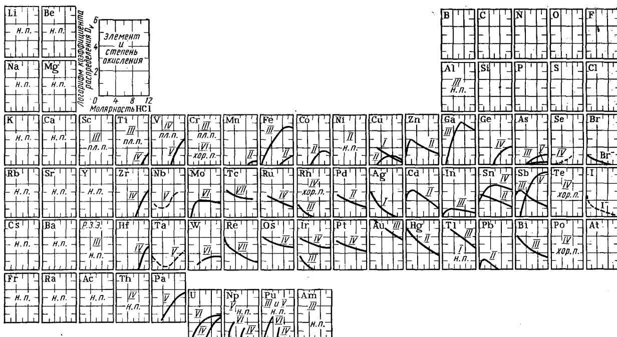
Поглощение элементов сильноосновным анионообменником Дауэкс-1 из растворов соляной кислоты различной концентрации*
