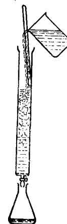
Рис. 62. Заполнение колонки навеской взвесью ионообменника
