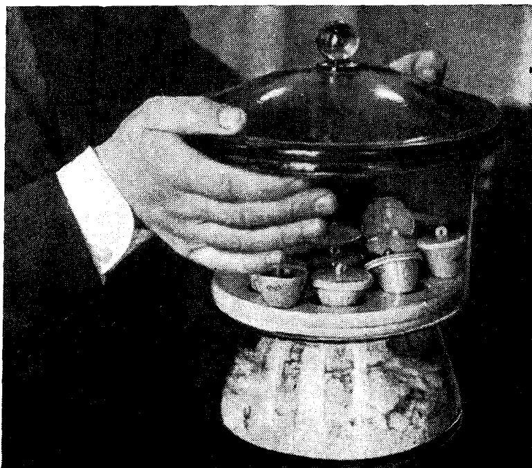
Рис. 40. Положение рук при переносе эксикатора
