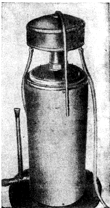
Рис. 13. Перегонный куб с электрическим обогревом
