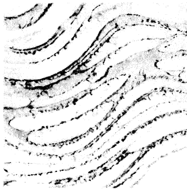
Рис. 7.21. Сечение экструдата, параллельное направлению течения, для смеси 10% полиэтилена и 90% полистирола при высокой скорости сдвига.
