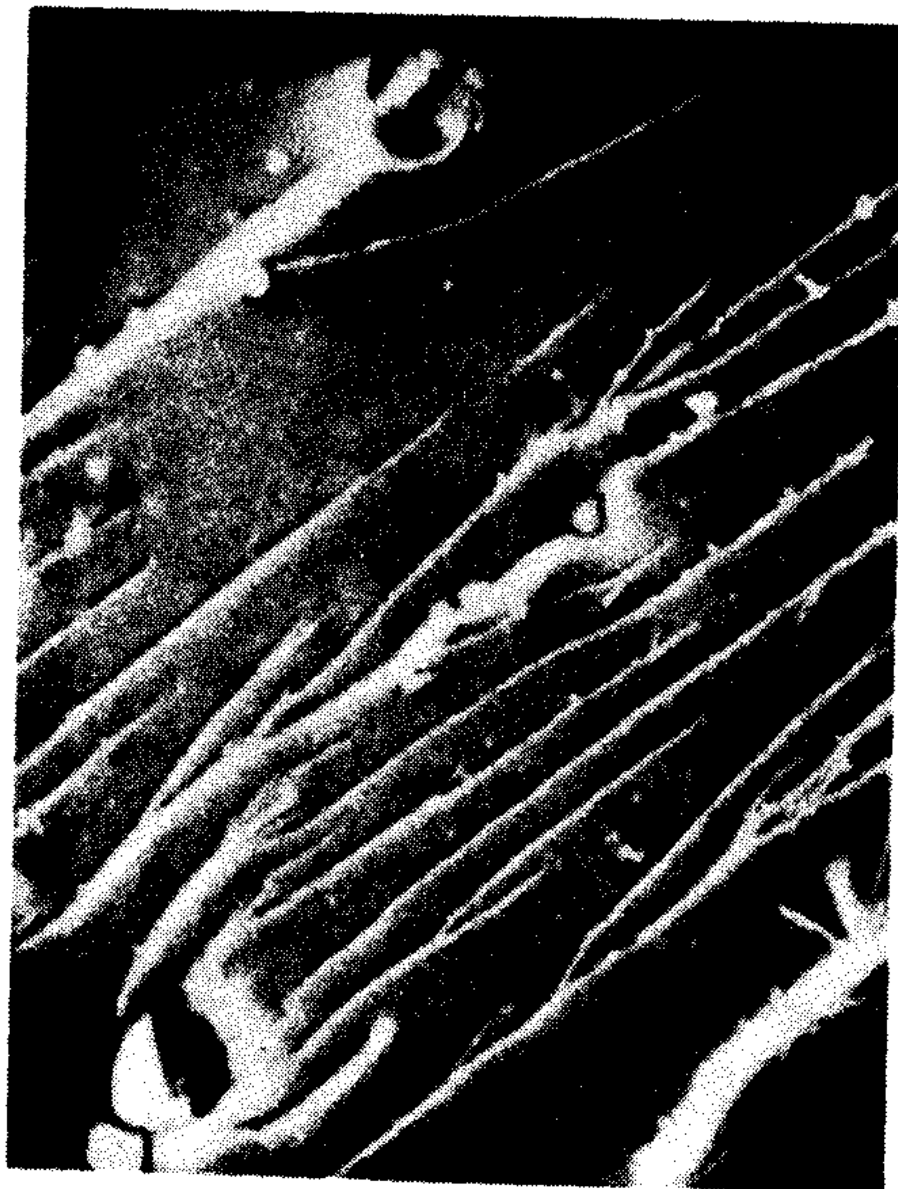
Рис. 23.14. Сканирующая электронная микрофотография смеси полистирола и полиэфира на основе изопталево́й кислоты. \times 500 .
