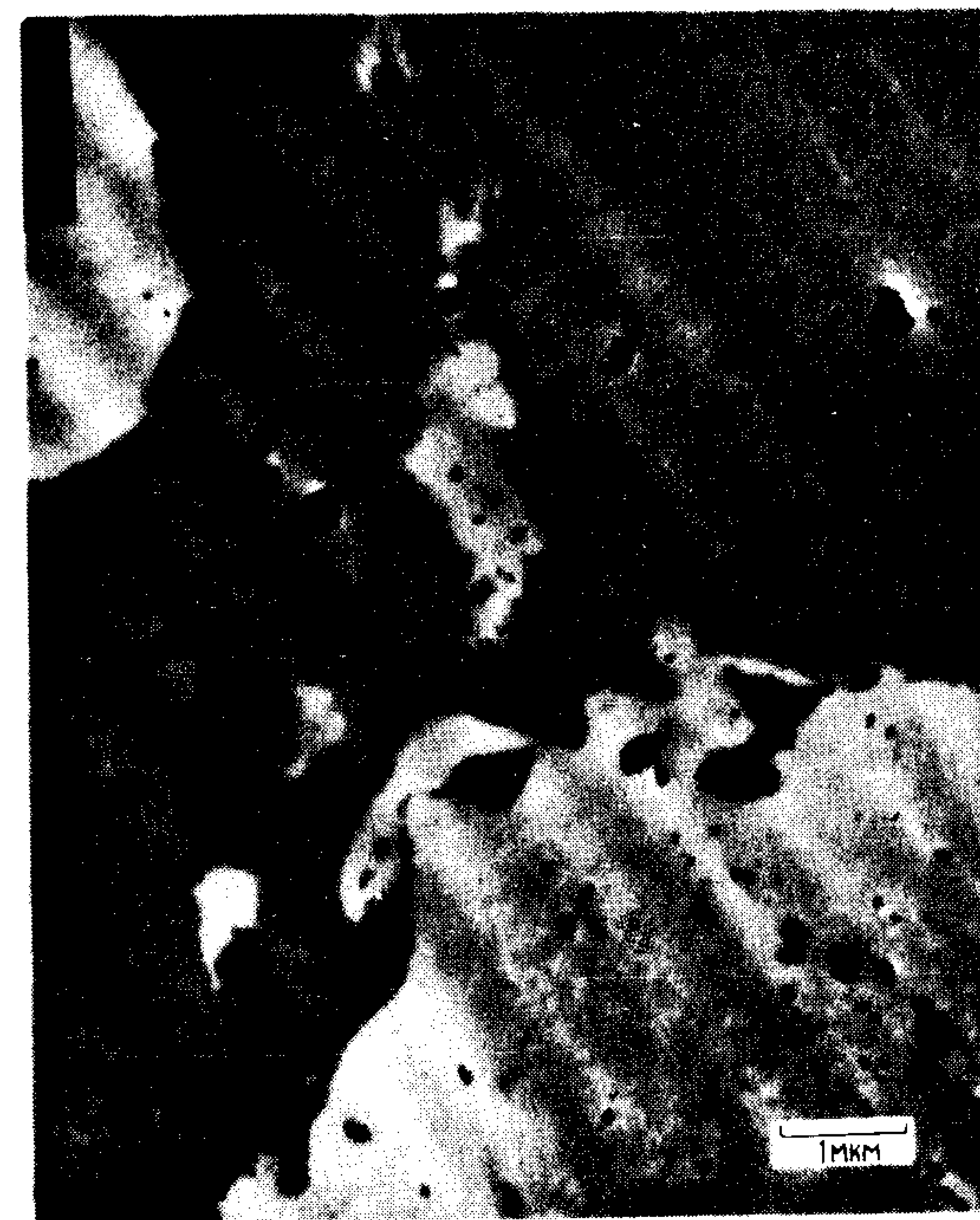
Рис. 19.2. Размеры областей дисперсной эластомерной фазы. Смесь (75:25) БСК—ПБК получена смешением в течение 1 мин на вальцах при температуре 25°C. Фаза ПБК более светлая [12, рис. 9].
