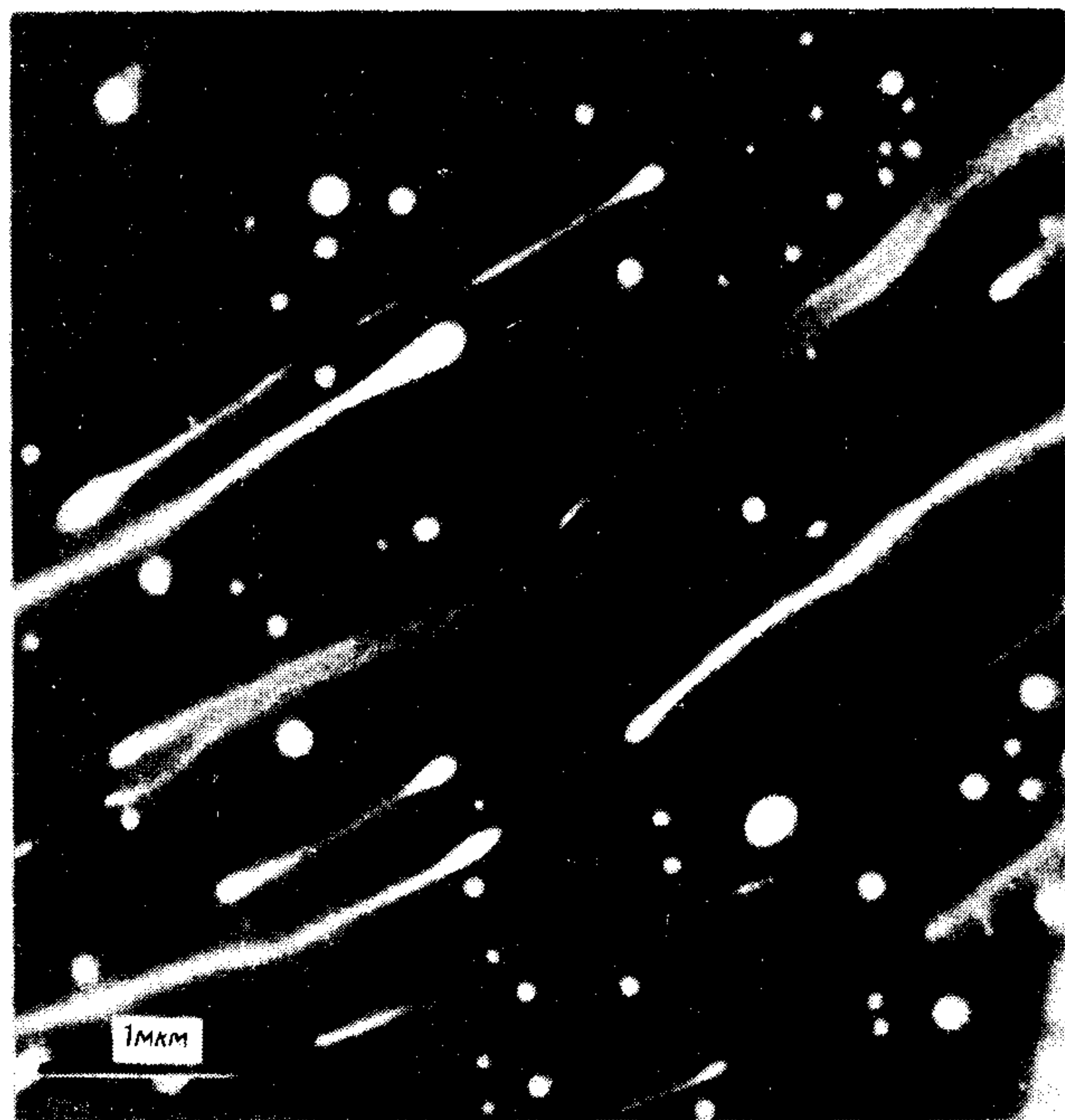
Рис. 15.7. Электронная микрофотография, демонстрирующая распад слоев ПММА [9].
