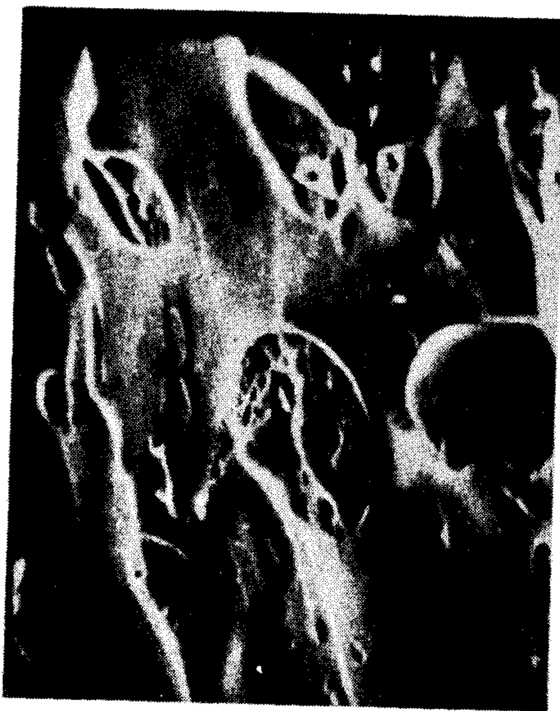
Рис. 23.13. Сканирующая электронная микрофотография смеси полистирола и полиэфира на основе малеинового ангидрида и пропиленгликоля. \times 500 .
