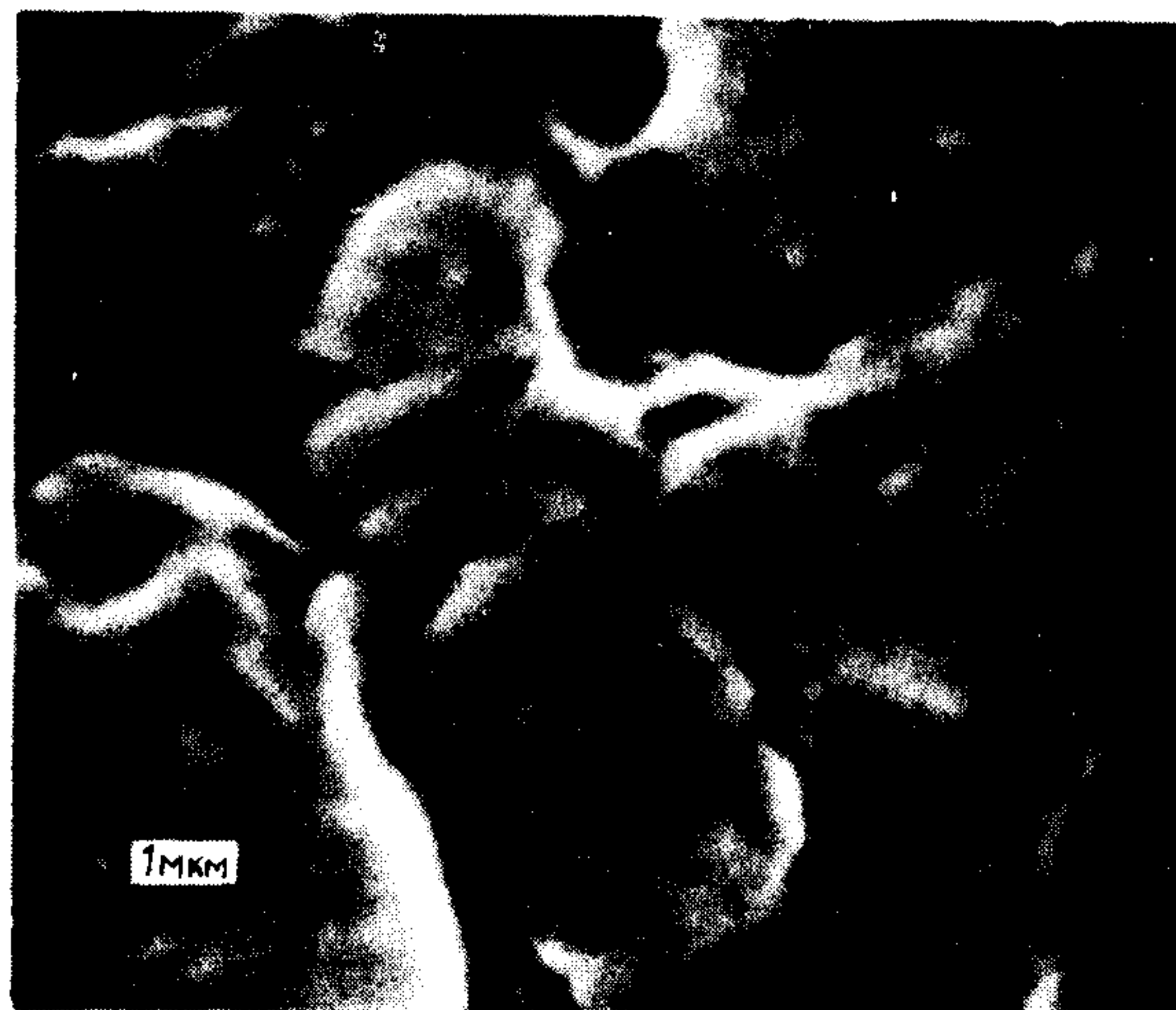
Рис. 20.4. Сканирующая электронная микрофотография поверхностного слоя бинарной смеси ЭПК с полипропиленом при их соотношении 70:30 после экстракции фазы ЭПК n -гептаном. Смесь получена методом литья под давлением.
