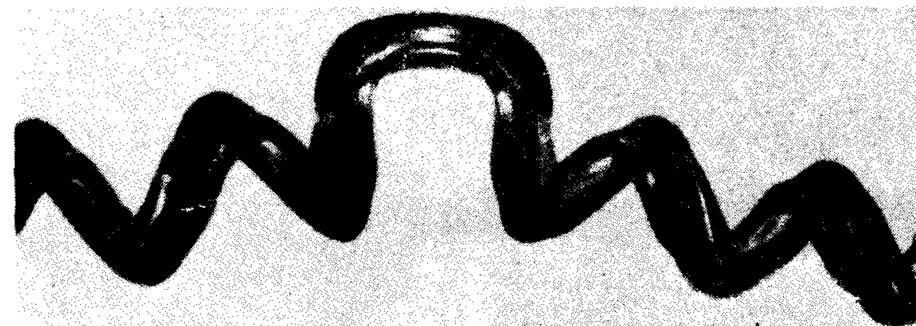
Рис. 16.13. Микрофотография обращения извитости в акриловом бикомпонентном волокне.
