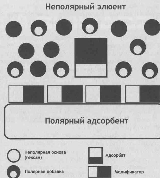
Рис. 2.5. Схема приповерхностного слоя в нормально-фазовой системе
