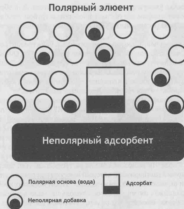
Рис. 2.4. Схема приповерхностного слоя в обращенно-фазовой системе
