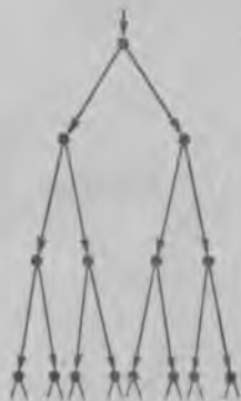
Рис. 82. Схема разветвленной цепной реакции
