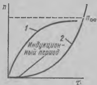
Рис. 85. Кинетическая кривая накопления активных частиц ( n ) в разветвленной цепной реакции для случая, когда разветвления происходят реже обрывов:
