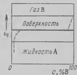
Рис. 89. Схема распределения концентрации газа в двойном диффузионном слое при малой растворимости газа в жидкости
