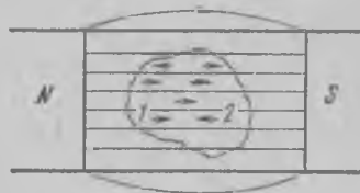
Рис. 24. Расположение атомов парамагнетика в поле постоянного магнита (в состоянии 1 находится большее число атомов, чем в состоянии 2)
