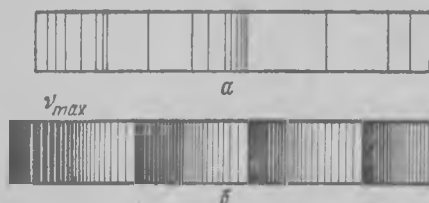
Рис. 14. Линейчатый спектр атомов (а) и полосатый спектр молекулы (б)
