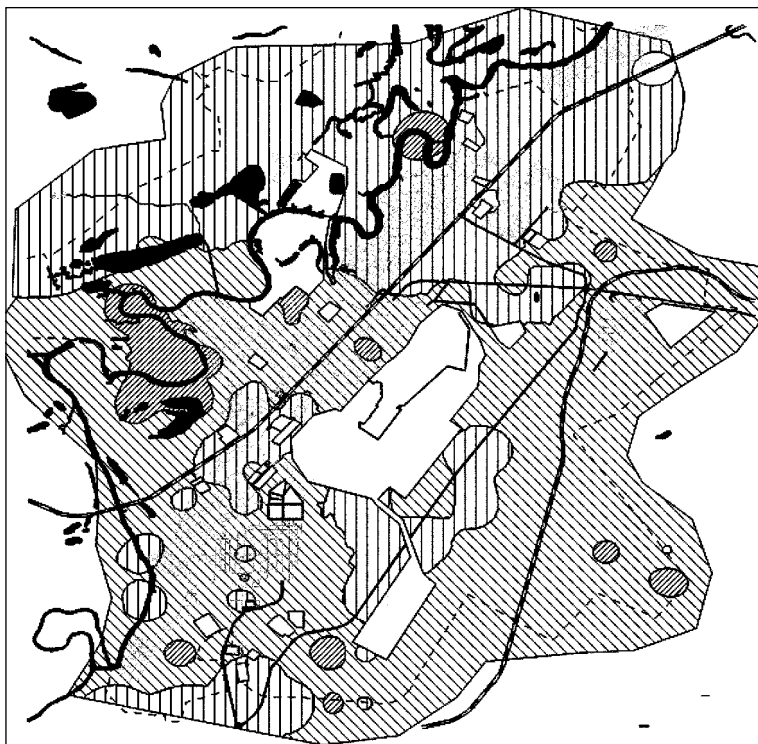
Рис.7. Содержание мышьяка в верхнем горизонте почв г. Чапаевска вне заводских территорий (в единицах превышения ПДК) 639 . Линии с наклоном направо обозначают городские территории, где ПДК по мышьяку превышаются в 2–3 раза. Линии с наклоном налево — территории, где имеется 3–5 единиц превышения ПДК. Вертикальные линии обозначают места с 0–2 единицами ПДК по мышьяку.
