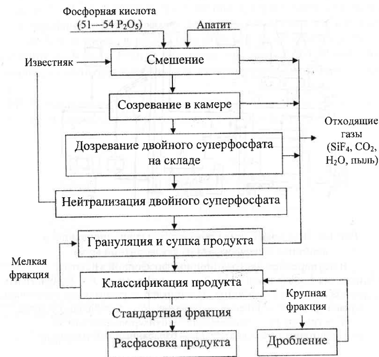
Рис. 1.1. Получение двойного суперфосфата камерным способом
