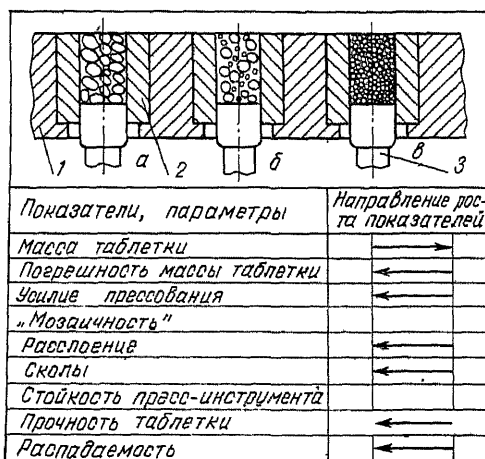
Рис. 29. Погрешность дозирования в зависимости от гранулометрического состава таблетлируемого материала.
