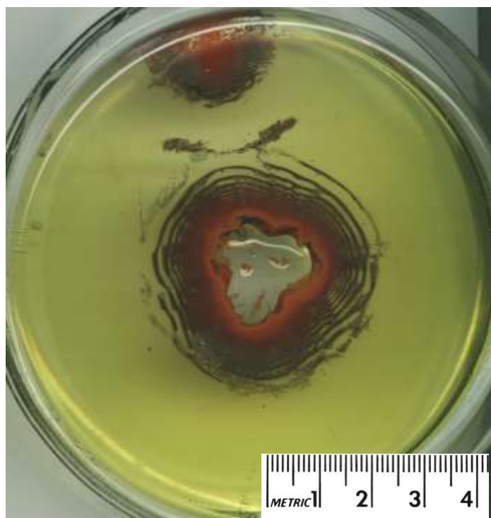
Рис. 3.3. Отсканированное изображение распределения осадка бихромата серебра. Исходные концентрации реагентов C(\text{AgNO}_3) = 0,5 \text{ M} , C(\text{K}_2\text{Cr}_2\text{O}_7) = 0,015 \text{ M} ; концентрация желатины - 6% масс. Толщина гелевого слоя - 5 мм
