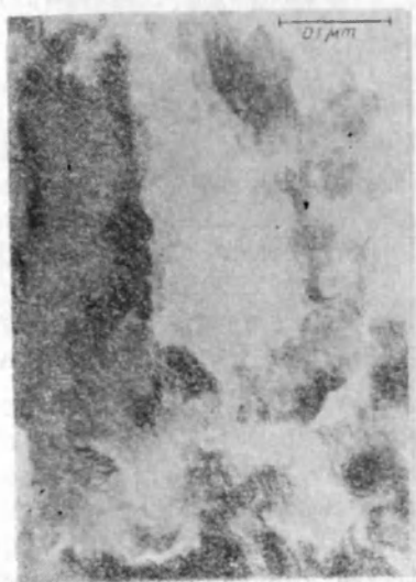
Рис. 34. Снимок чистого осажденного гидроксида алюминия ( \times 100\,000 ) без частиц рутила
