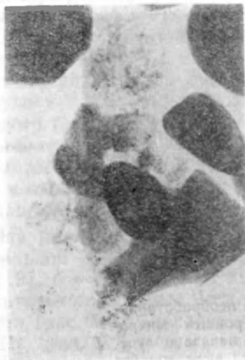
Рис. 33. Электронномикроскопические снимки рутила ( \times 100\,000 ), обработанного 6% диоксида кремния: а — при облучении пучком с силой тока 2 \mu\text{A} ; б — то же 60 \mu\text{A}
