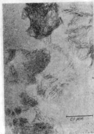
Рис. 35. Снимок чистого осажденного гидроксида кремния ( \times 100\,000 ) без частиц рутила
