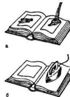
Рис.11. Приемы удаления жирных и масляных пятен с листов книги с использованием впитывающих жиры порошков (сорбентов): а - присыпание пятна порошком сорбента; б - проглаживание загрязненного места горячим утюгом
