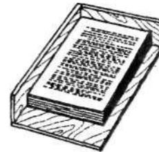
Рис.16. Уголковы ящик для сборки стопы листов или тетрадей
