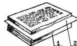
Рис.7. Сушка книжного блока после устранения разрывов листов и подклейки заплата: 1 - книжный блок; 2 - Прокладка из парафинированной бумаги или полиэтиленовой пленки
