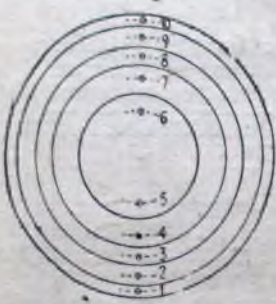
Рис. 24. Положения трубки Пито при проходке с 10 измерительными точками.
