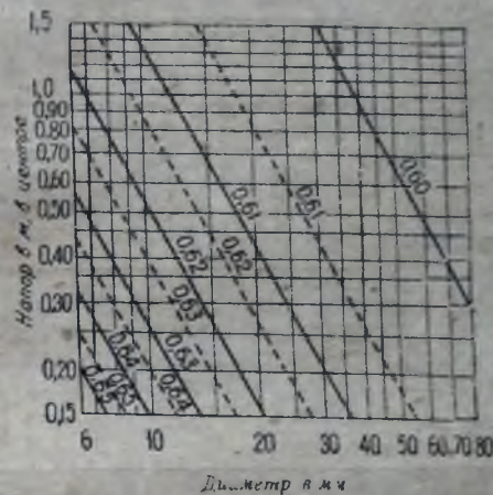
Рис. 35. Коэффициенты для течения через прямоугольные диафрагмы с выпуском в газонаполненную среду.
