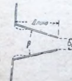
Рис. 36. Коническое сопло Кастеля.
