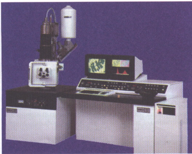
Рис. 23. Сканирующий электронный микроскоп «Amray» с приставкой для определения микроэлементного состава объекта
