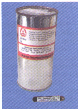
Рис. 21. Запаянная ампула с четырехокисью осмия дополнительно упаковывается в металлический контейнер
