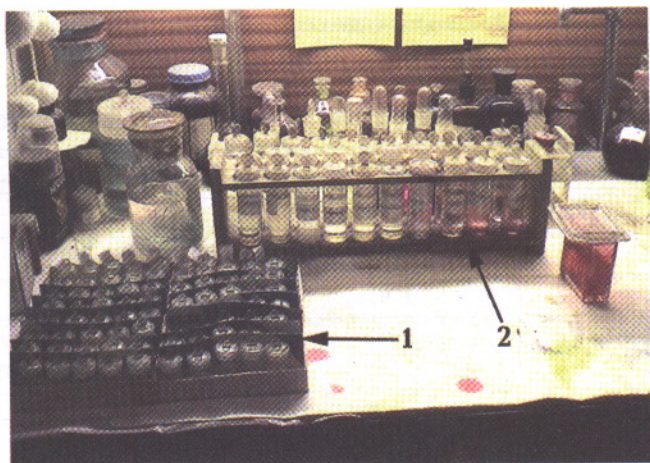
Рис. 1. Общий вид батареи для обезвоживания: 1 — фиксированных объектов; 2 — обезвоживания-оводнения готовых срезов на предметных стеклах
