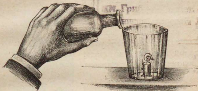
Рис. 6. Углекислый газъ тушитъ свѣчу.
