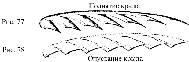
Поперечное сечение механизма махового пера
