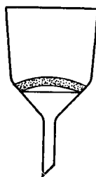
Р и с. 35. Фильтр со стеклянной пористой пластинкой.
