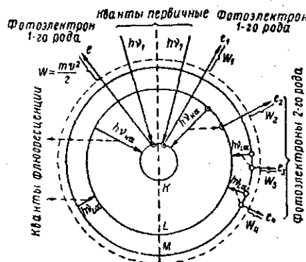
Рис. 5-3. Схема поглощения квантов рентгеновского излучения с испусканием характеристического излучения (слева) и с испусканием электронов второго рода (справа).
