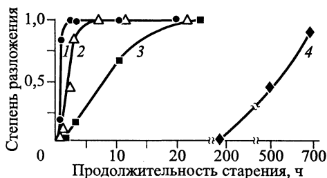
Рис. 48. Влияние продолжительности старения в воде на степень разложения гидроксида меди при различных температурах:
